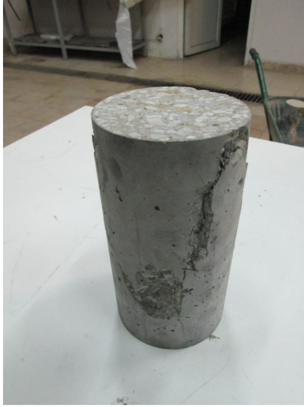
Şekil A.3. Basınç numunelerin kırılma şekli.
