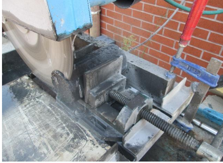
Şekil 3.11. Silindir numunelerin pürzölü taraflarının kesilmesi.
