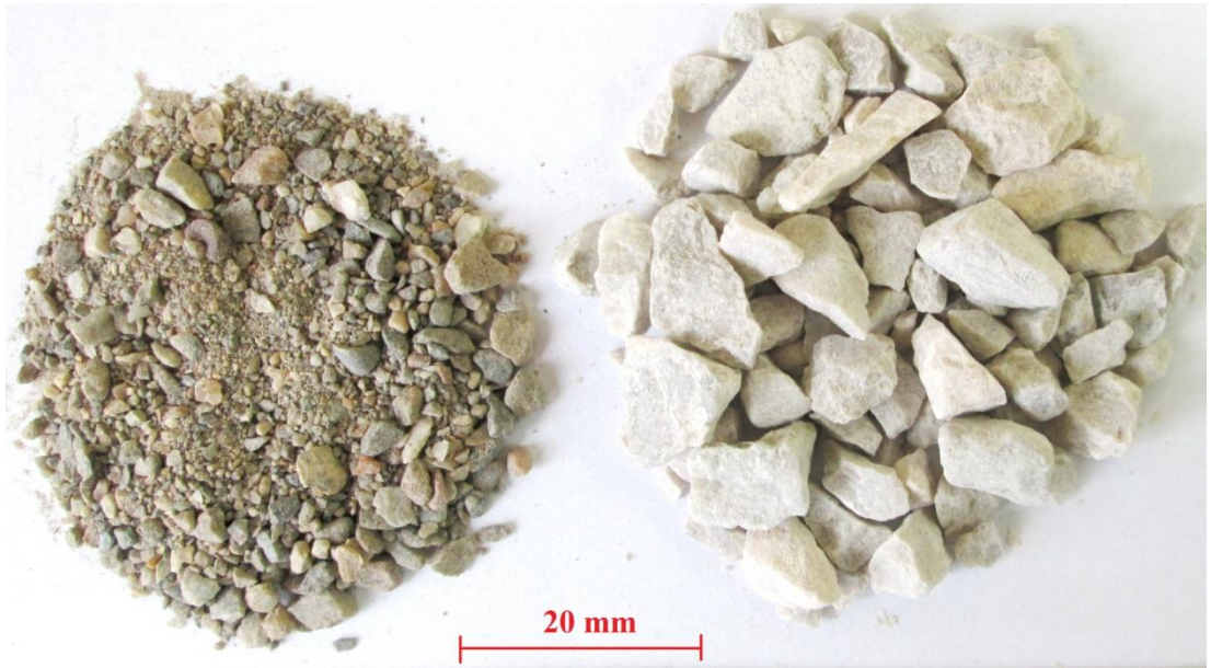
Şekil 3.3. 0-0.5 mm (sol) ve 5-15 mm (sağ) Agregat tipi.
