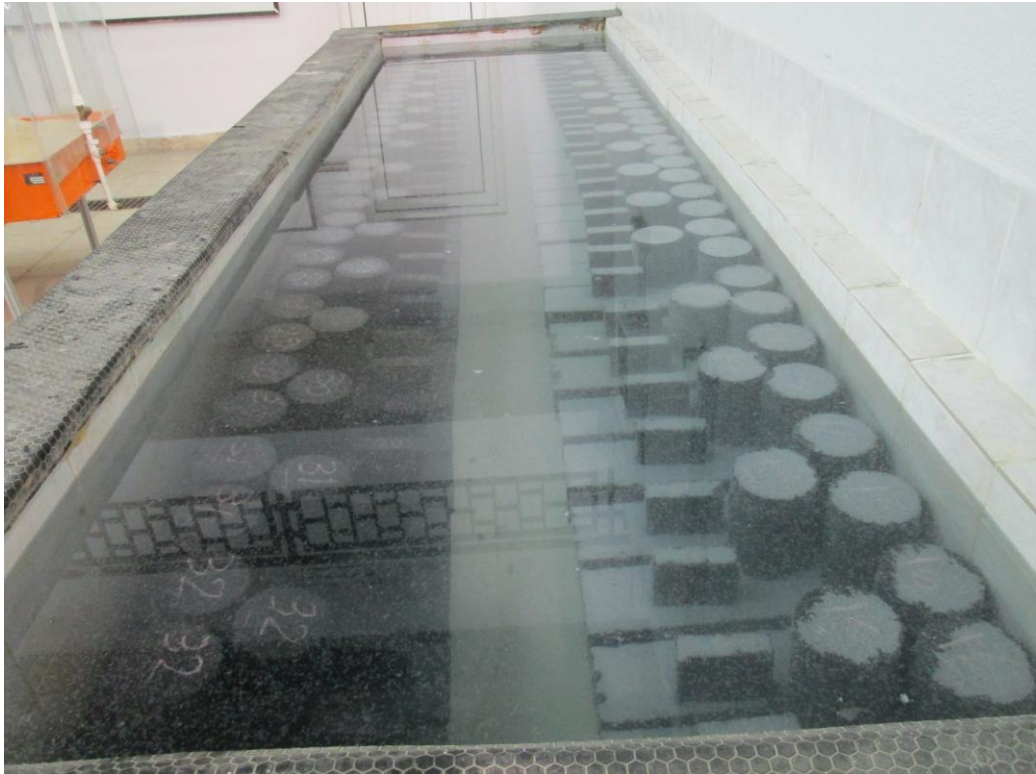
Şekil 3.10. Numunelerin kür havuzunda yerleştirilmesi.
