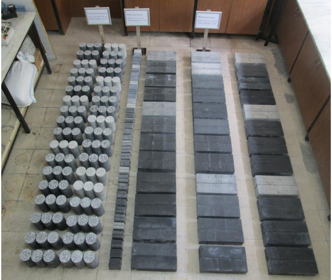
Şekil 3.12. Numunelerin oda sıcaklığında kurutulması.
