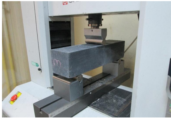
Şekil 3.13. Basınç (üst) ve eğilme (alt) test cihazları.
