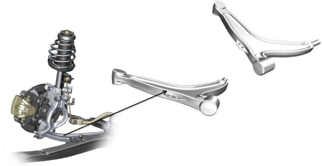
Şekil 4.1 Salıncak kolu parçasının tasarım modellemesi [26]
