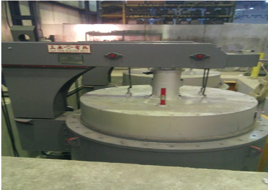
Şekil 3.6. T6 ısıt işlem fırını
