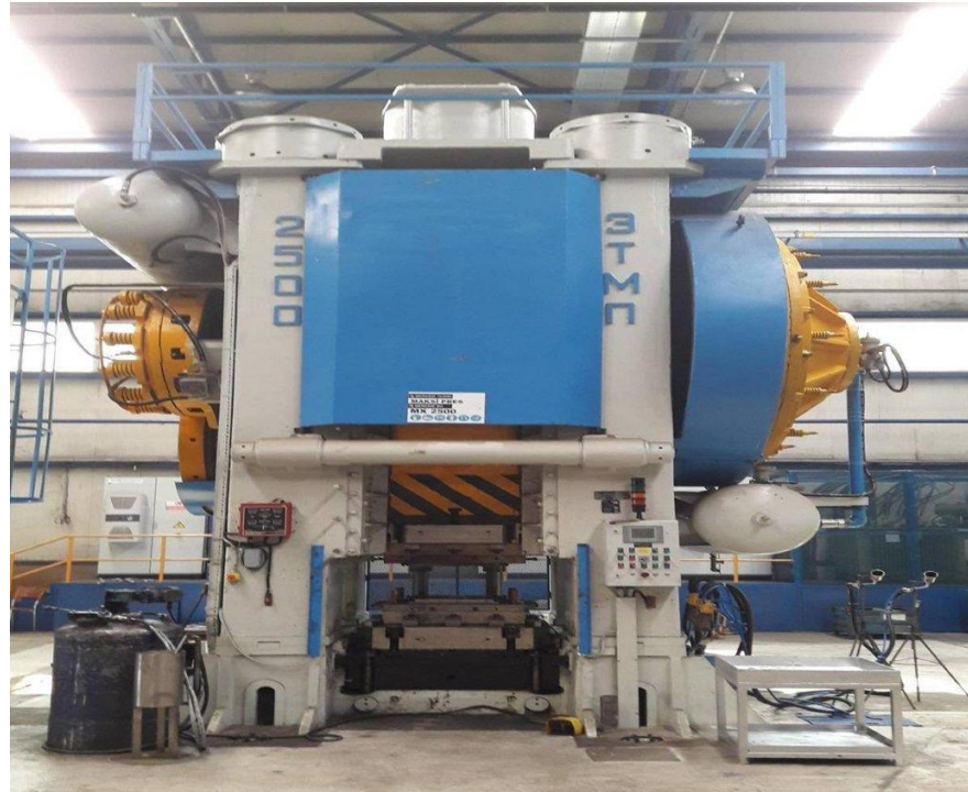
Şekil 3.2. 2500 tonluk maxi pres makinesi
