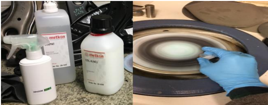
Şekil 4.15. Parlatmada kullanılan yağlayıcılar ve parlatma işlemi
