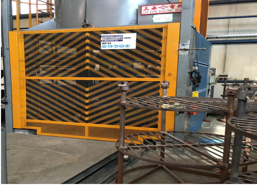
Şekil 3.5. T4 ısıt işlem fırını
