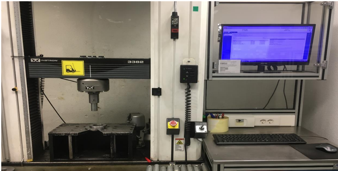
Şekil 4.10. Instron 3382 Çekme Basma Test Cihazı
