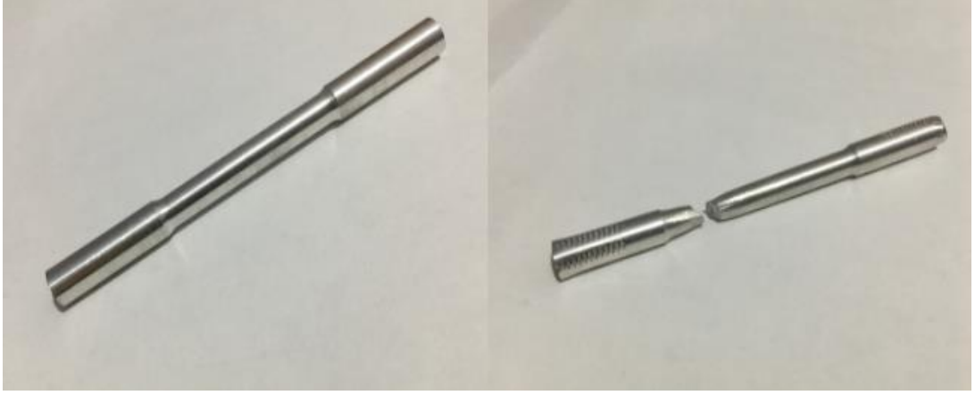
Şekil 4.11. Hazırlanan bir çekme numunesi ve test sonrasında kopmuş hali
