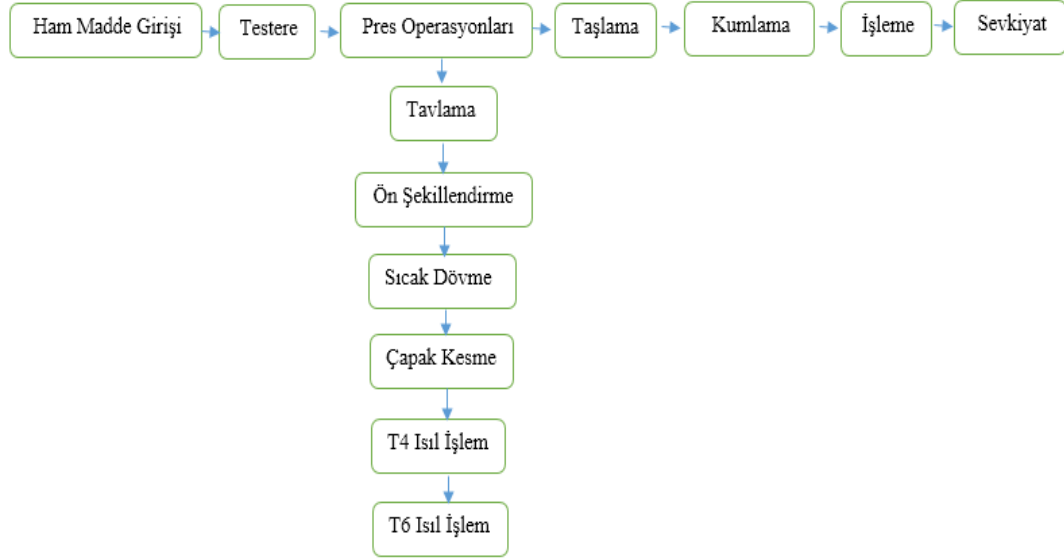
Şekil 3.1. Dövme alüminyum parçaların üretim akış şeması
