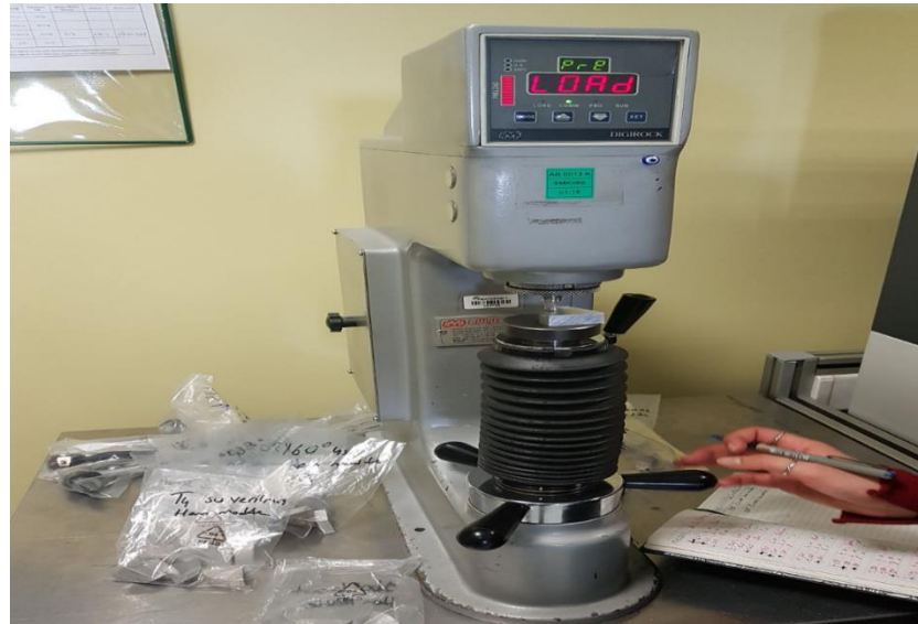
Şekil 4.12. DIGIROCK-RB Dijital Rockwell & Brinell Sertlik Ölçme Cihazı
