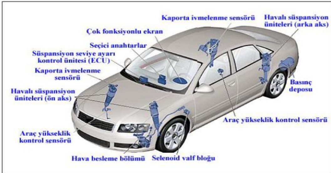
Şekil 2.10. Aktif süspansiyon sistemi elemanları [7]
