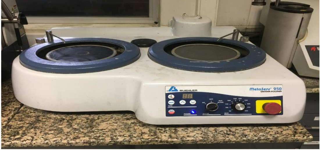
Şekil 4.14. Taşlama ve parlatma makinesi
