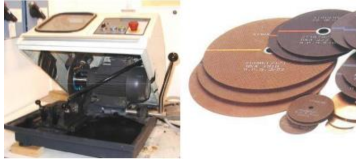
Şekil 4.13. Kesme cihazı ve abrasiv aşındırıcılı kesme disk çeşitleri
