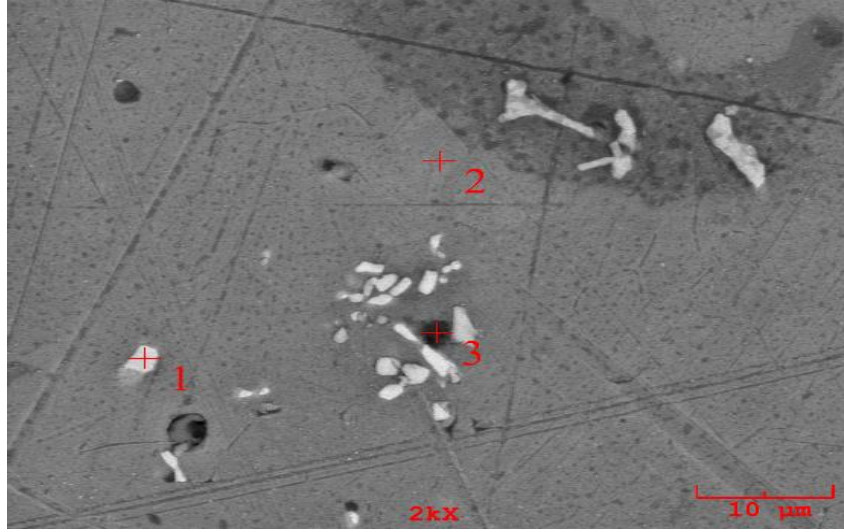
Şekil 5.2. 160° de 4 saat süreyle ısıtılmış dövülmüş numunenin SEM görüntüsü(2)
