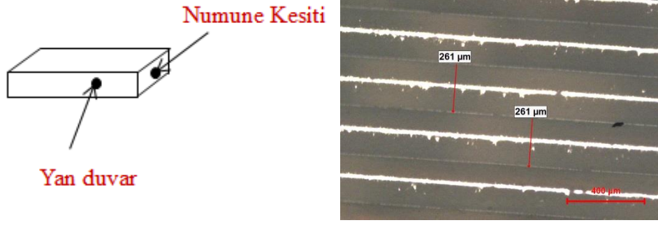
Şekil 4.21. Deney numunelerinin şematik gösterimi ve yan duvarına ait optik mikroskop görüntüsü
