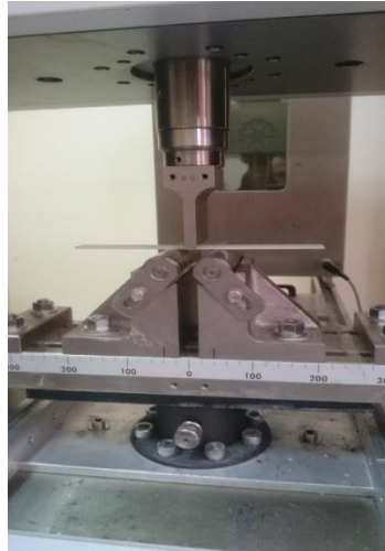
Şekil 4.15. Hızlı prototipleme ile üretilen numuneye ait üç nokta eğme testi
