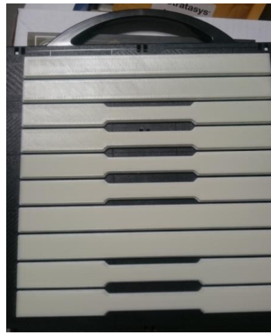
Şekil 4.5. Hızlı protoipleme yöntemi ile üretilen çekme ve eğme numuneleri
