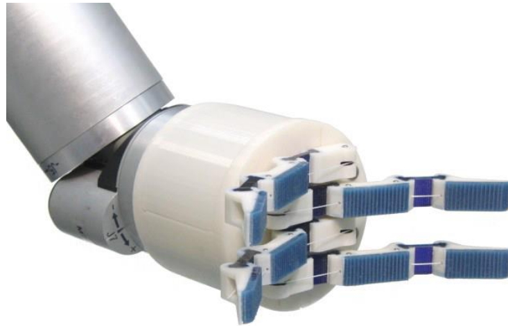
Şekil 1.5. 3d baskı yöntemiyle üretilmiş bir robot el uygulaması [5]
