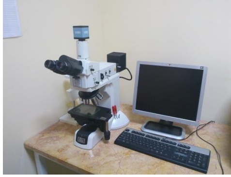
Şekil 4.20. Deney numunelerinin incelendiği Nikon Eclipse LV150 mikroskobunun görüntüsü
