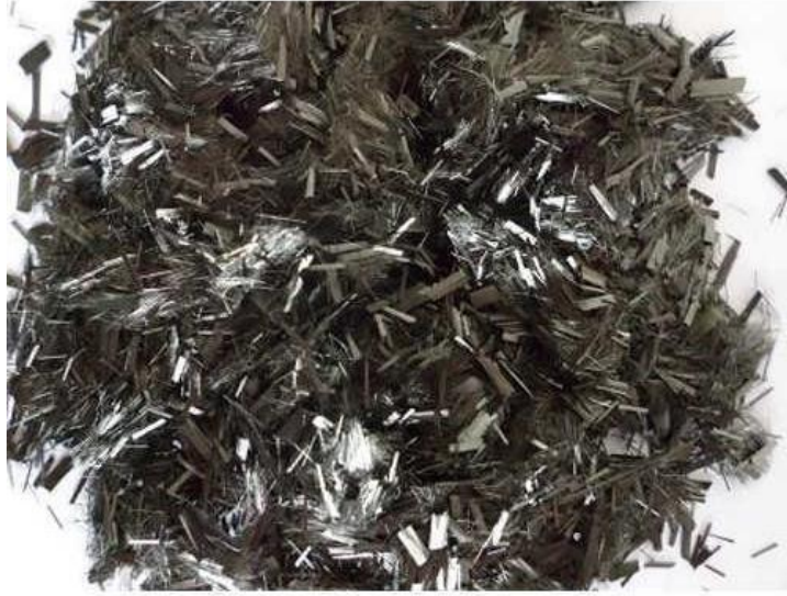
Şekil 2.21. Kırpık Karbon Elyaf
