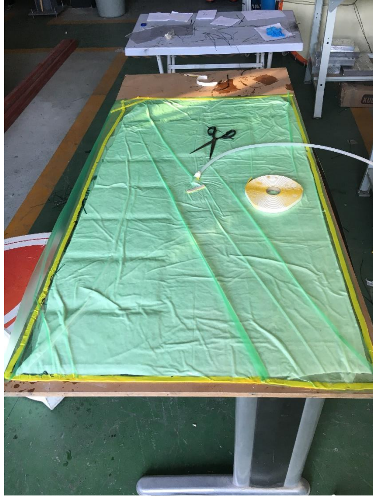
Şekil 3.13. Vakum Altında Kürlenme
