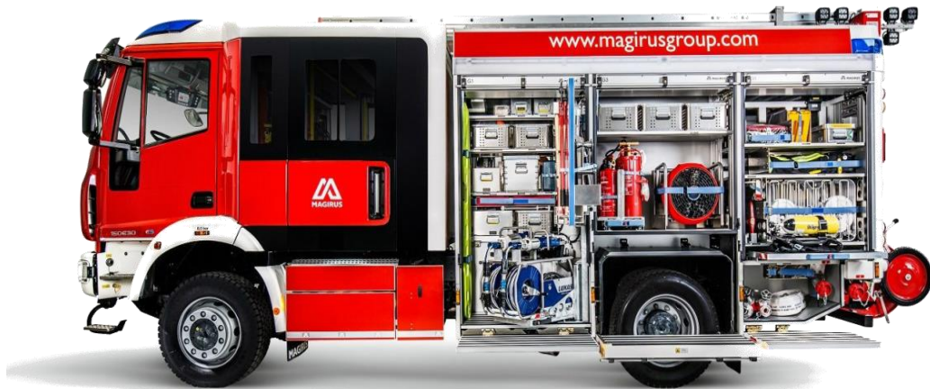
Şekil 3.12. Çift Kabin Maksatlı Yangına Müdahale Aracı
