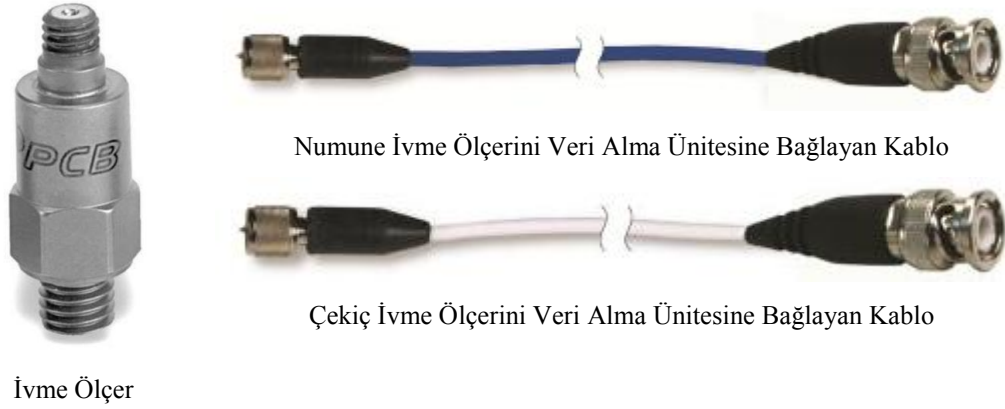
Şekil 3.7. Kullanılan ivme ölçer ve kablolar[24]
