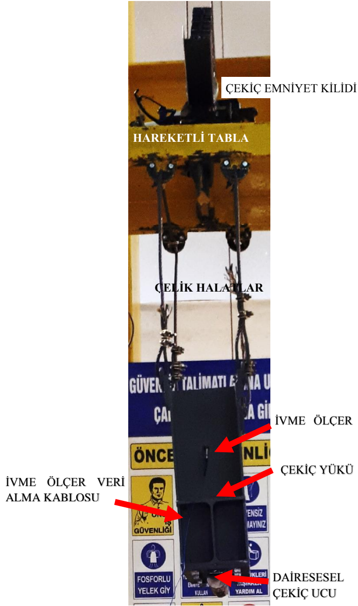
Şekil 3.13. Çekiç Yüğü ve Çekiç Sistemi
