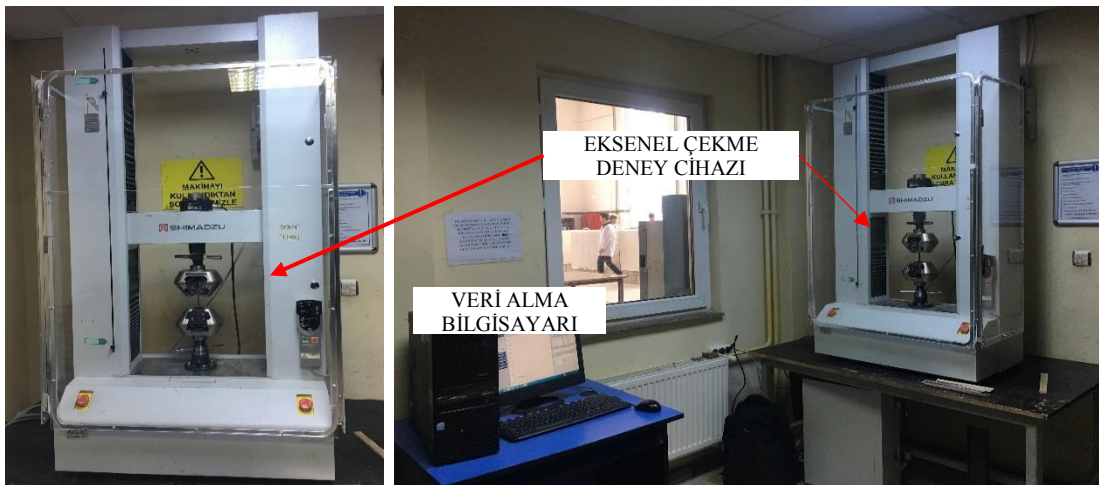
Şekil 3.2. Eksenel çekme deney cihazı
