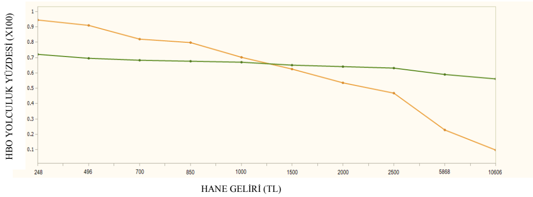
Şekil 6.51. GeneXpro Tools 5.0 programına göre hane geliri ile hane gelirine bağlı olarak üretilen ev tabanlı-diğer yolculuk oranları arasındaki matematiksel ilişki (Test veri seti değerleri için)
