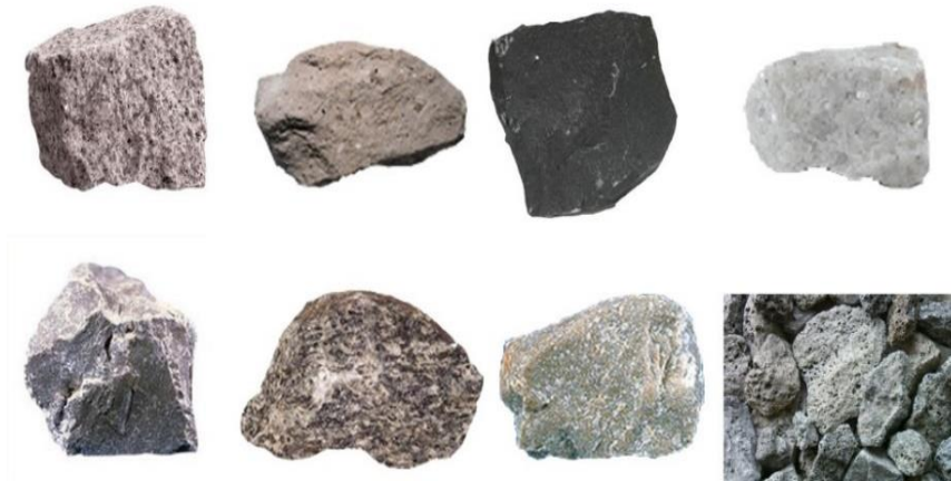
Şekil 3.29. Balast malzemesi olarak çeşitli kayaç örnekleri
