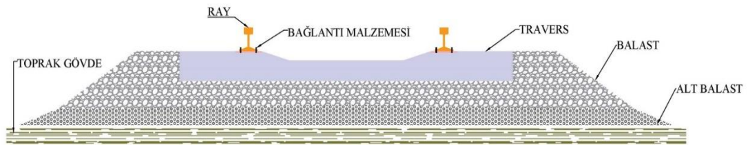
Şekil 3.2. Balastlı demiryolu üstyapısını oluşturan bileşenler
