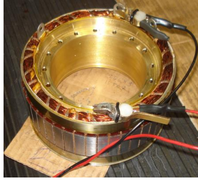
Şekil 5.17. İkaz rotoru presbantlardan sonra izolasyon testi
