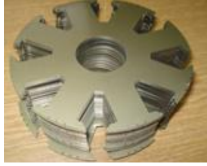
Şekil 5.11. Ana rotor silisli saçlarının paketlenmesi
