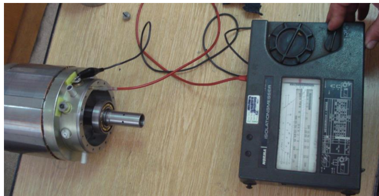
Şekil 5.19. Ana rotor izolasyon direncinin ölçülmesi
