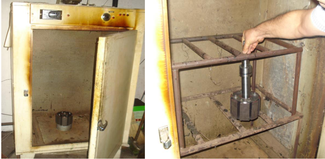
Şekil 5.13. Nüvenin fırınlanması ve rotor milinin montajı
