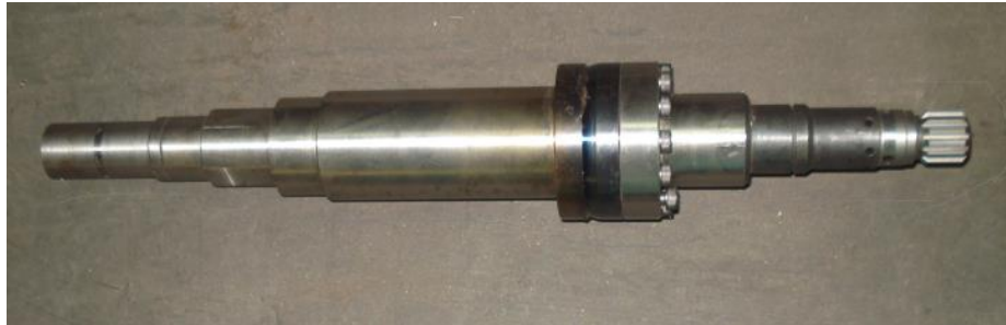
Şekil 5.10. Montajı yapılmış rotor mili
