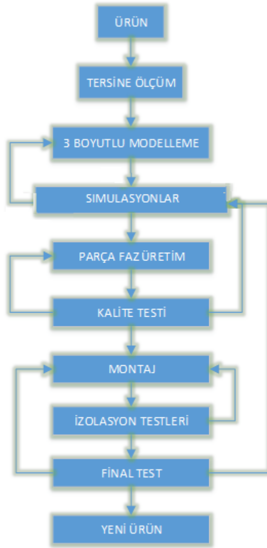
Şekil 3.3. Rotor imalat akış şeması
