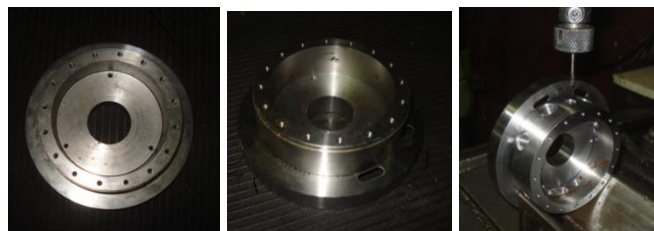
Şekil 5.3. Alan sargı rotor disk eksi tarafı delikler açılırken
