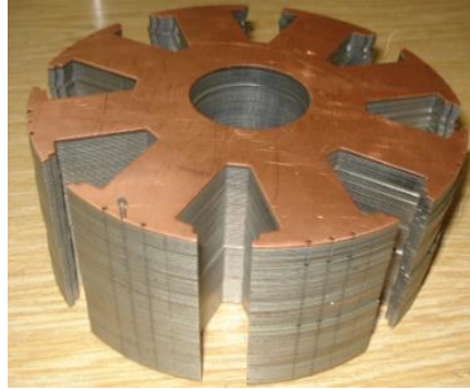
Şekil 5.12. Bakır saçla paketlenen ana rotor silisli saçları
