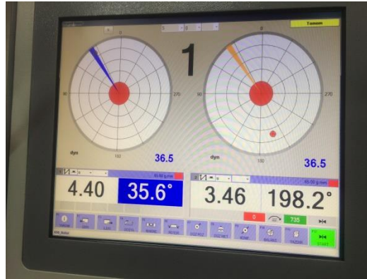
Şekil 5.22. Rotorun balans ölçümü
