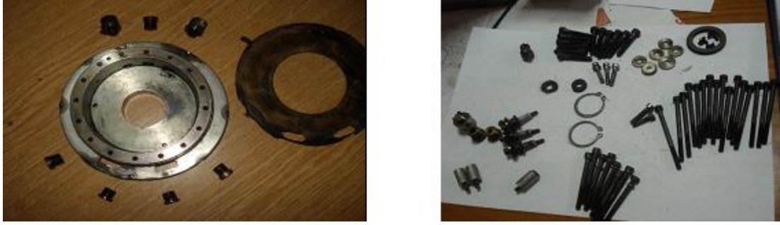
Şekil 4.4. Rotor disk, disk presbantı ve bağlantı vidaları(soldaki), ve rotora ait vida, segman, pul ve burçlar (sağdaki)
