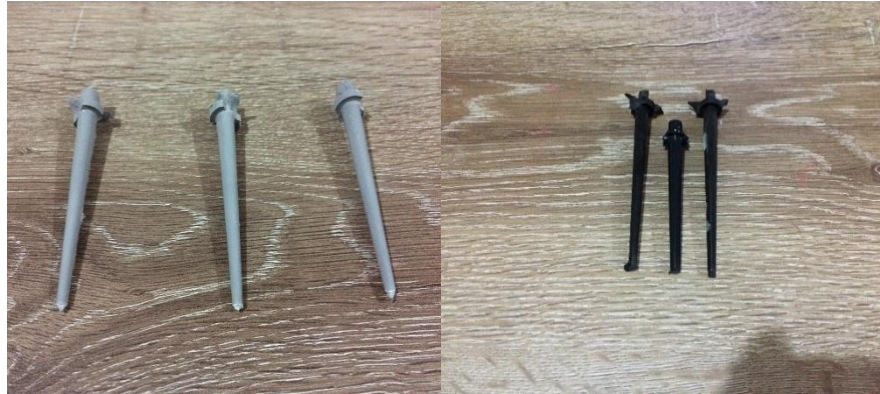
Şekil 3.2. PPS polimeri ve PPS kompozit malzeme numuneleri
