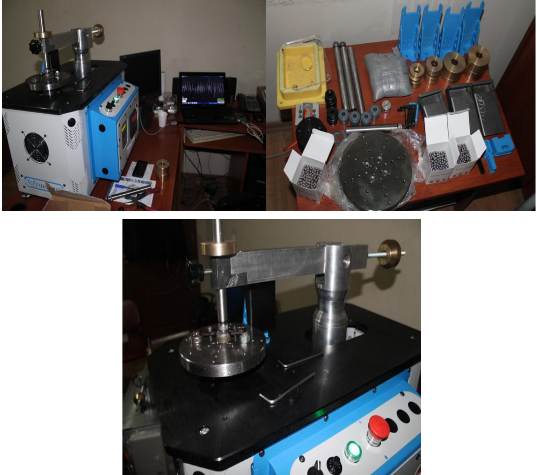
Şekil 3.3. Pim disk aşınma cihazı
