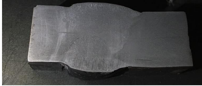
Şekil 4.16. Bazık elektrod ile kaynaklı X70 çeliğinin makro yapı görüntüsü
