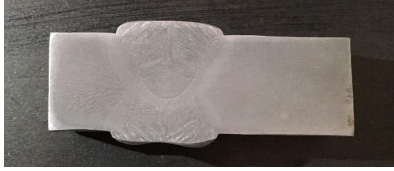
Şekil 4.15. Tozaltı kaynak tekniği ile kaynaklı St 52 çeliğinin makro yapı görüntüsü
