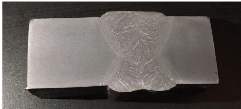
Şekil 4.14. Tozaltı kaynak tekniği ile kaynaklı X70 çeliğinin makro yapı görüntüsü
