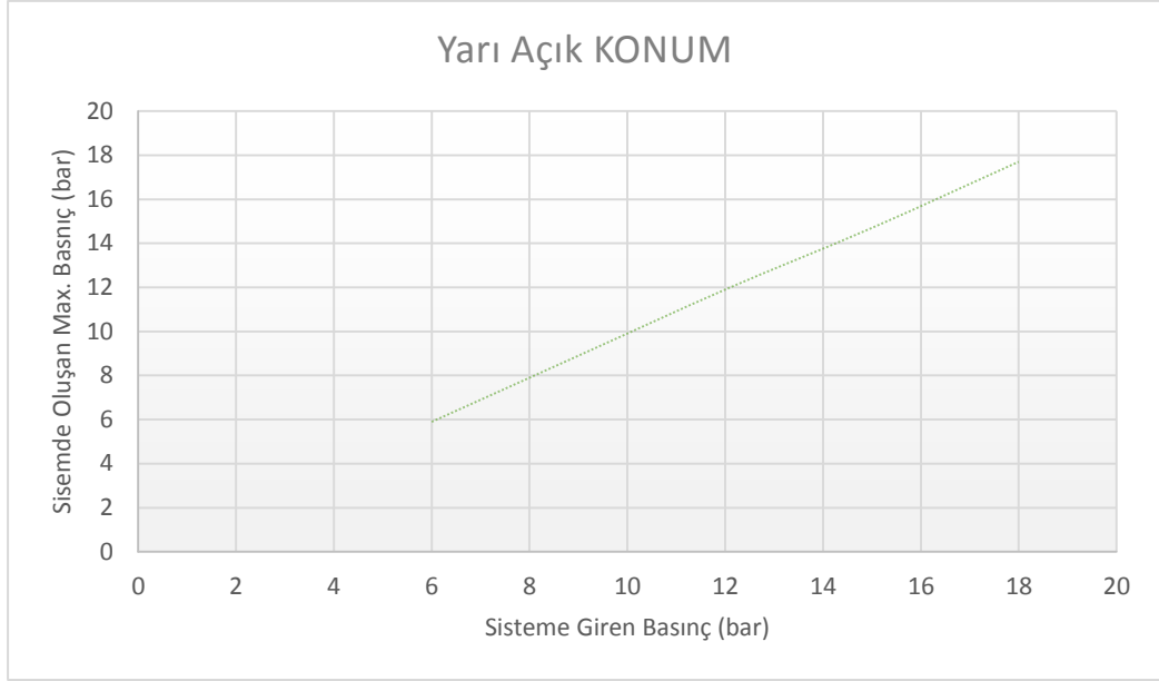
Şekil 7.8. Yarı açık konumda sistemdeki basınç değişimi
