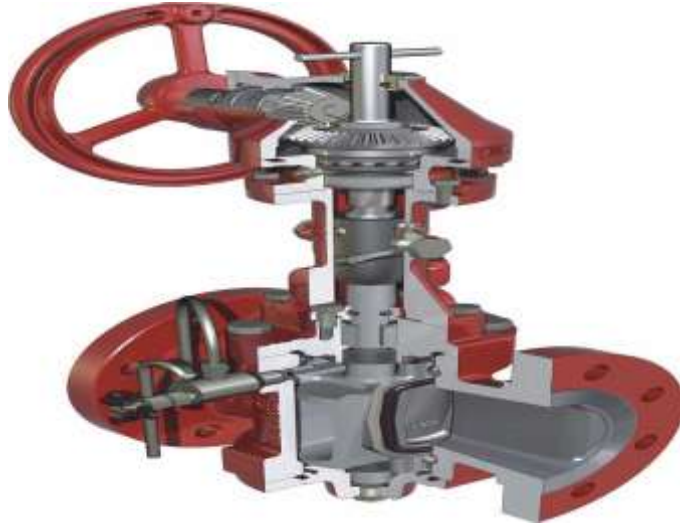
Şekil 6.14. Vananın tam montajlı kesit resmi
