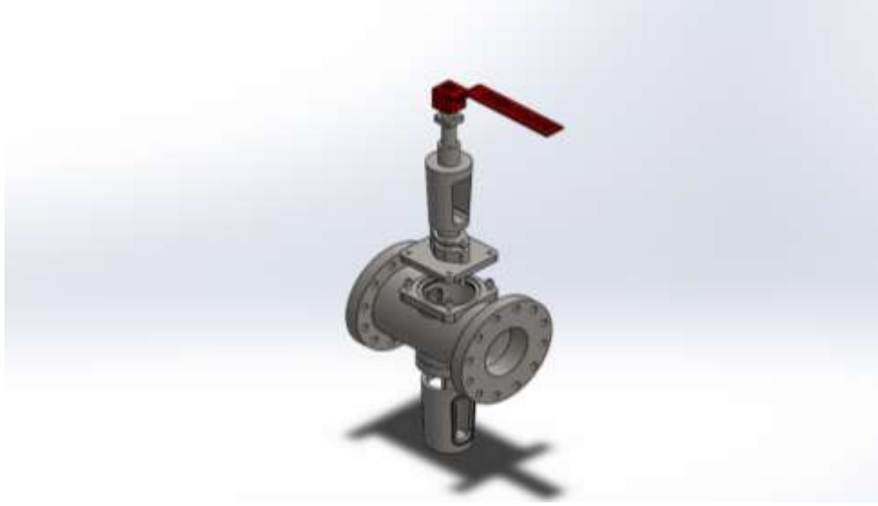
Şekil 6.8. Plug Vana patlatılmış montaj görünümü
