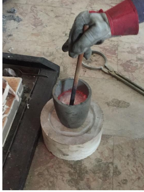
Şekil 3.3. Deneyde kullanılan pota ve alaşımın homojenliğinin sağlanması için karıştırılma işlemi
