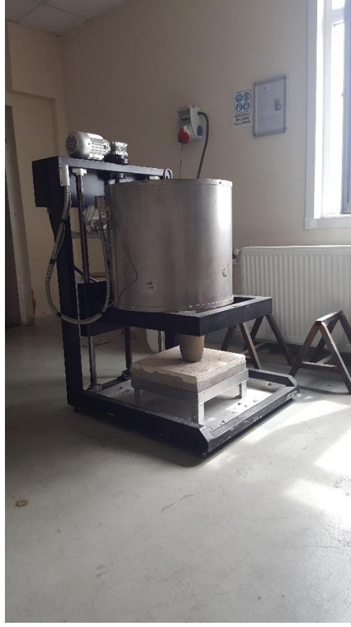
Şekil 3.2. Denelerde malzemelerin eritilmesi için kullanılan elektrik dirençli fırın
