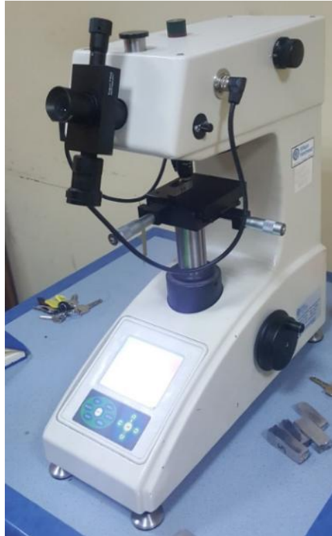
Şekil 3.19. Sertlik testlerinde kullanılan Vickers mikro-sertlik cihazı
