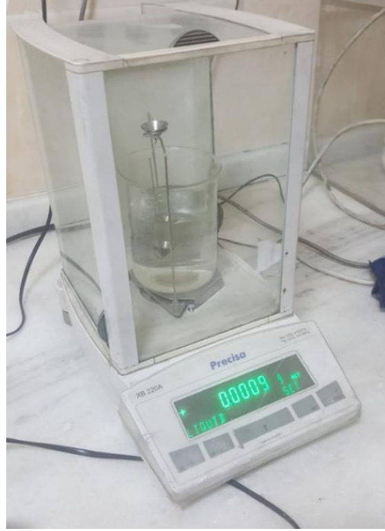
Şekil 3.22. Yoğunluk ölçümlerinde kullanılan Arşimet düzeneği
