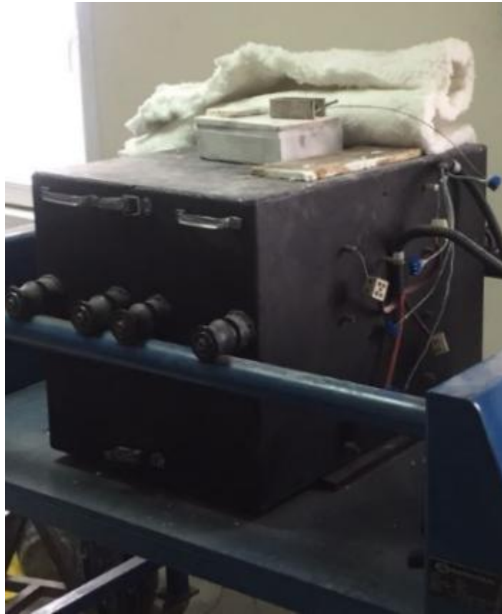
Şekil 3.8. Döküm işlemine hazır hale getirilmiş kontrollü katılma fırın görünümü
