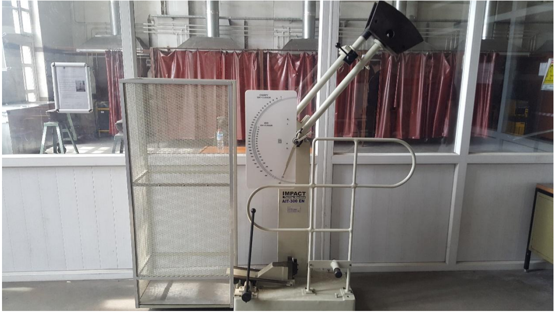
Şekil 3.20. Kırılma tokluğu ölçmek için kullanılan Charpy etki test cihazı
