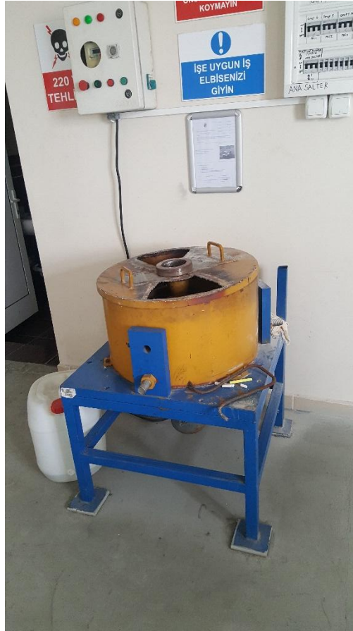
Şekil 3.5. Deneyde kullanılan dikey savurma döküm cihazı
