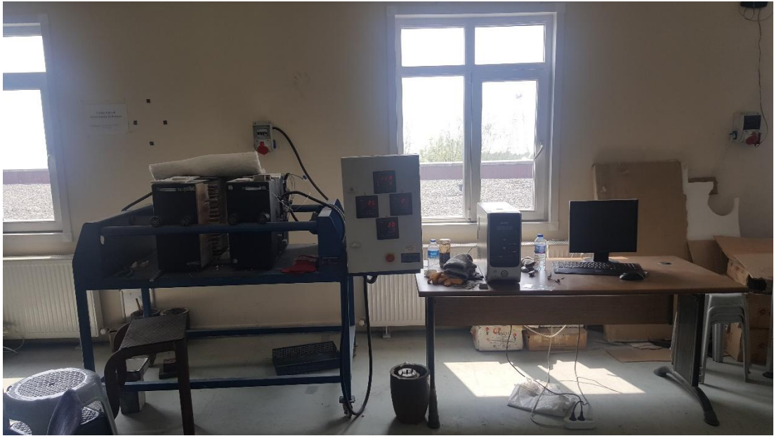
Şekil 3.7. Kontrollü katılma fırınının kurulumu
