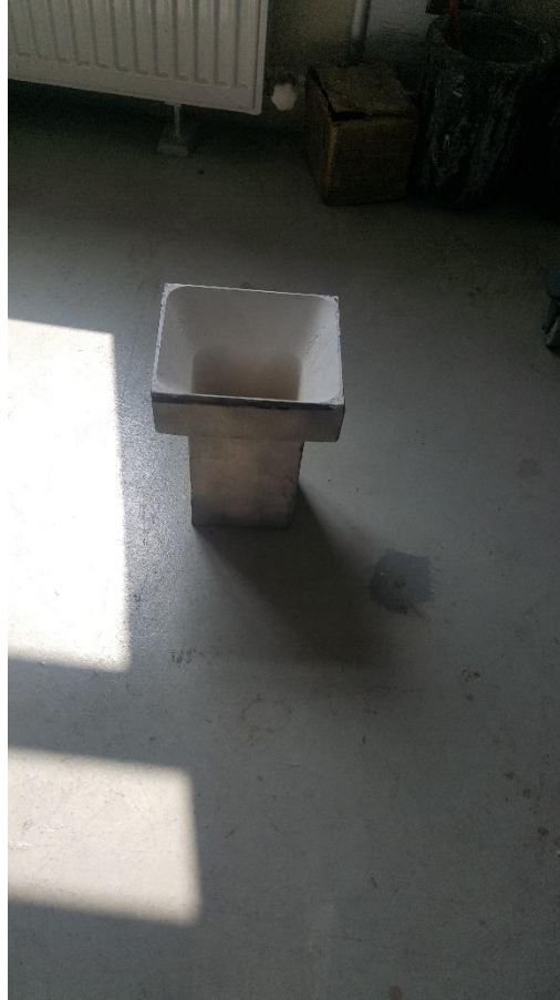
Şekil 3.6. Boyanıp döküme hazır hale getirilen kokil kalıp
