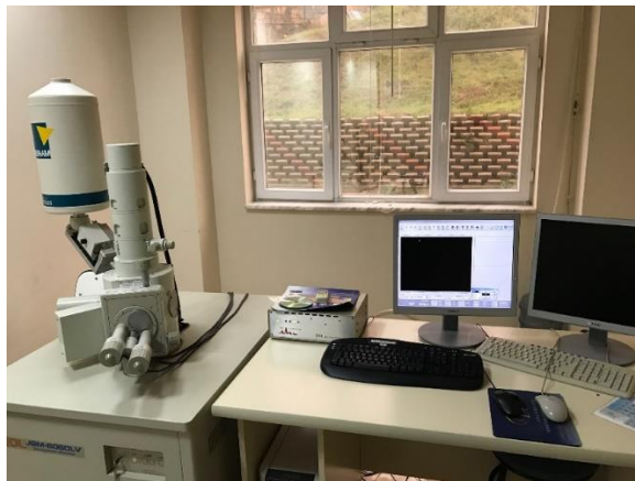
Şekil 5.13. Jeol 6060 LV taramalı elektron mikroskobu
