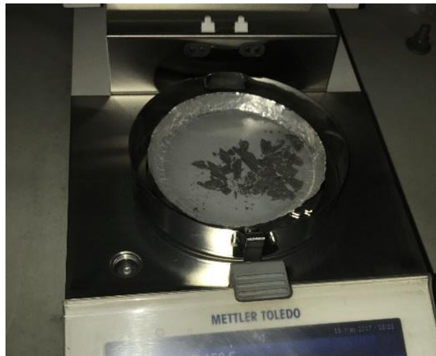
Şekil 5.5. Elektrot örtüsü nem kontrolü işlemi
