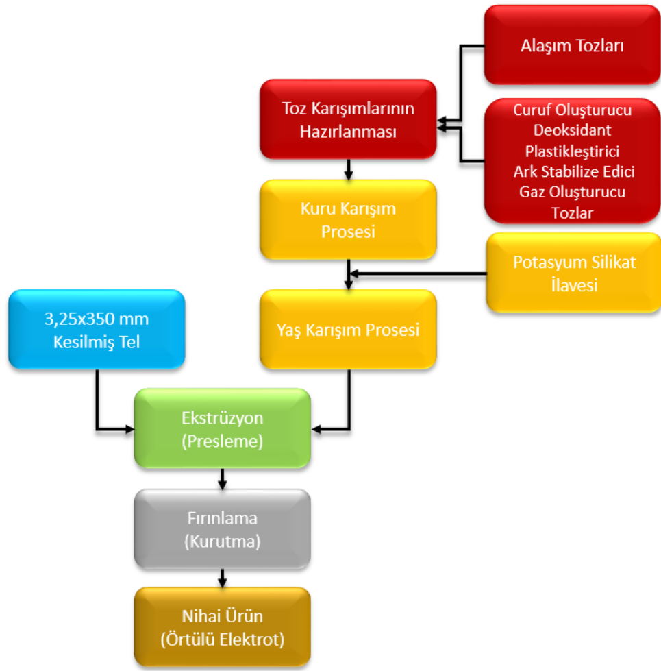
Şekil 5.1. Elektrot üretim süreç akım şeması
