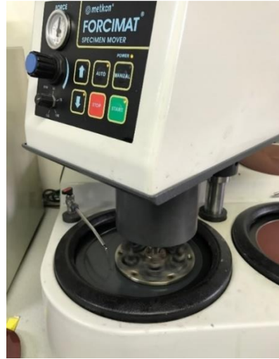
Şekil 5.10. Metkon Forcimat 2V metalografik numune hazırlama cihazı
