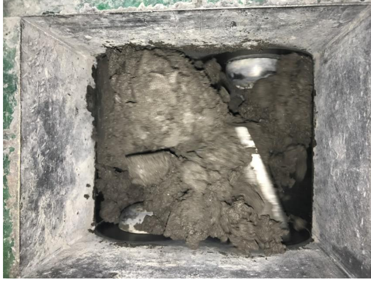
Şekil 5.2. Z bıçak sistemine sahip döner karıştırıcıda silikat ilavesi sonrası karışım işlemi
