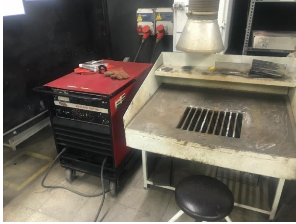
Şekil 5.7. Lincoln Electric-Ideal Arc R3R 500-I kaynak makinesi ve uygulama alanı.
