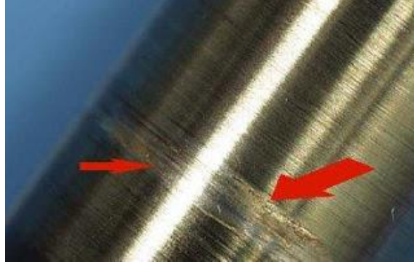
Şekil 3.3. Şaft mili üzerinde meydana gelen Sıyırma (Galling) aşınması ( http://mechanicsupport.blogspot.com.tr ; Erişim Tarihi: 10.02.18).
