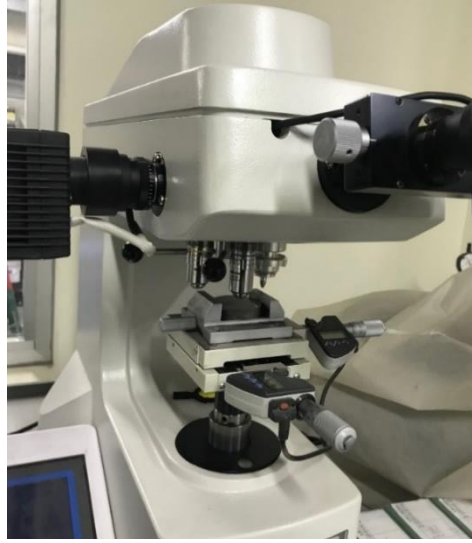
Şekil 5.14. Mitutoyo HM-112 Sertlik ölçüm cihazı
