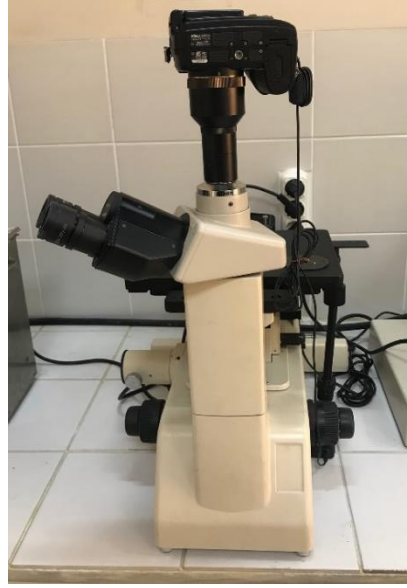
Şekil 5.11. Nikon Epiphot 200 optik mikroskop
