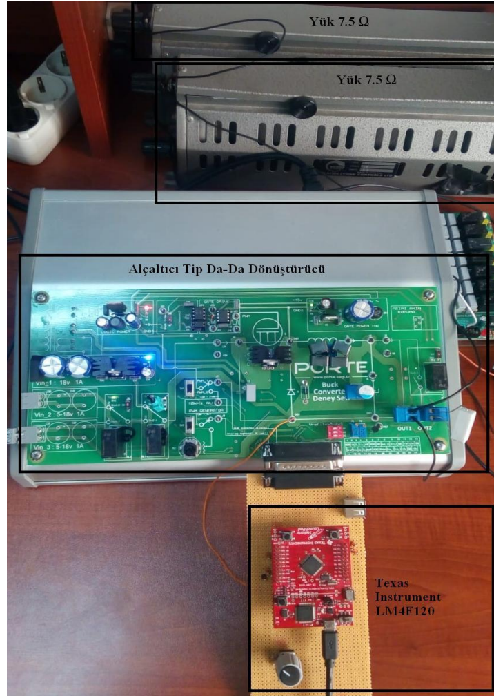
Şekil 5.1. Alçaltıcı tip DA-DA dönüştürücü devresinin prototipi.
