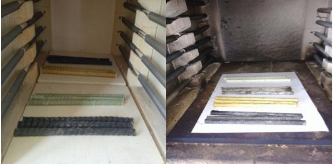
Şekil 4.5. FRP matris elemanlarının yakılması
