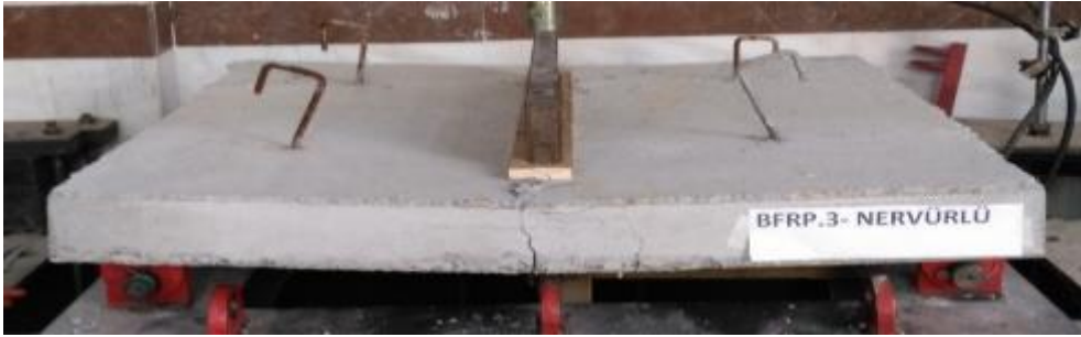
Şekil 4.70. BFRPN donatılı döşeme kırılma sonrası
