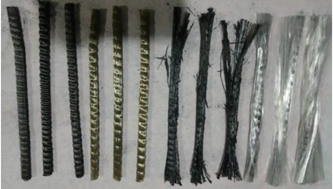
Şekil 4.6. Matris malzemesinin yakılma sonrası FRP lifler
