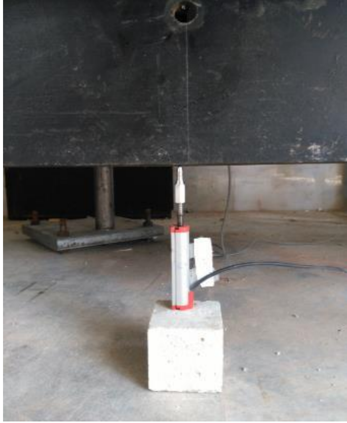
Şekil 4.34. Çerçeve sisteme yerleştirilmiş potansiyometre
