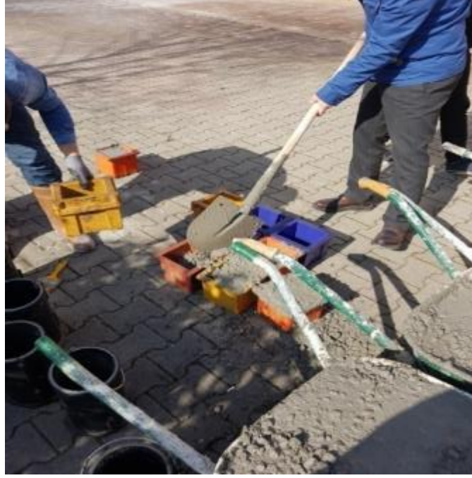
Şekil 4.24. Taze beton numune alma işlemi
