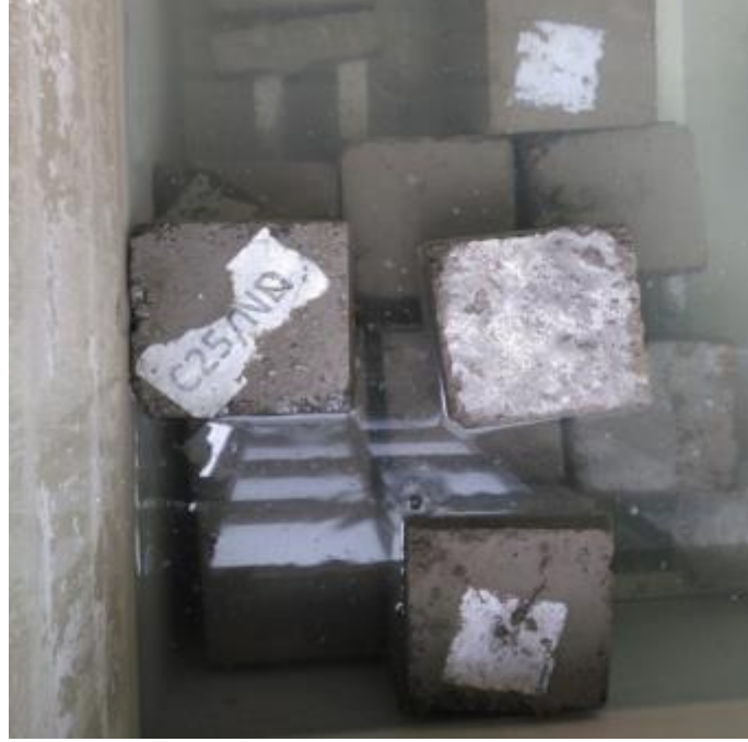
řekil 4.26. Beton numunelerin kr havuzunda bekletilmesi
