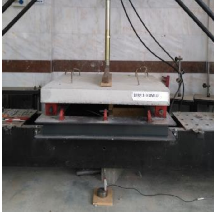
Şekil 4.39. BFRPK donatılı döşeme kırılma öncesi
