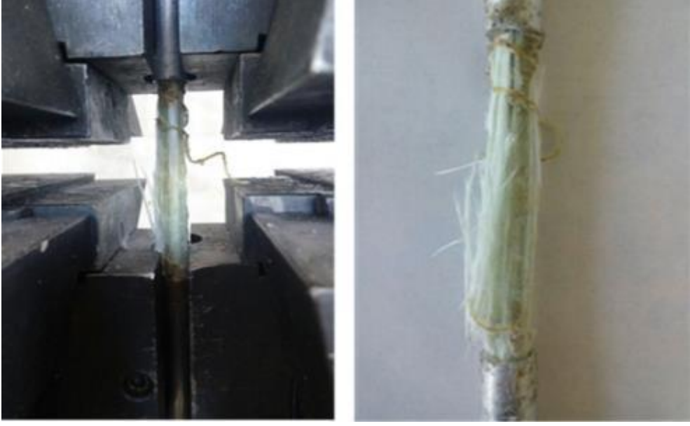
Şekil 4.13. GFRP donatıların çekme testleri
