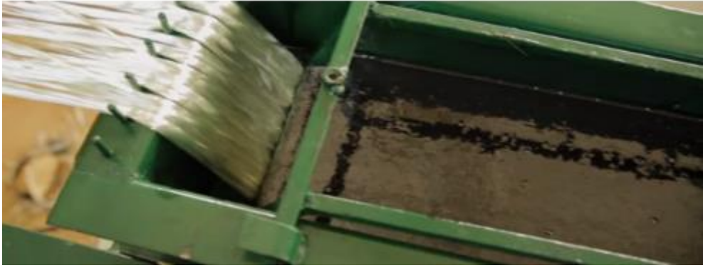
Şekil 3.3. FRP donatı çubukların üretiminde reçine işlemi
