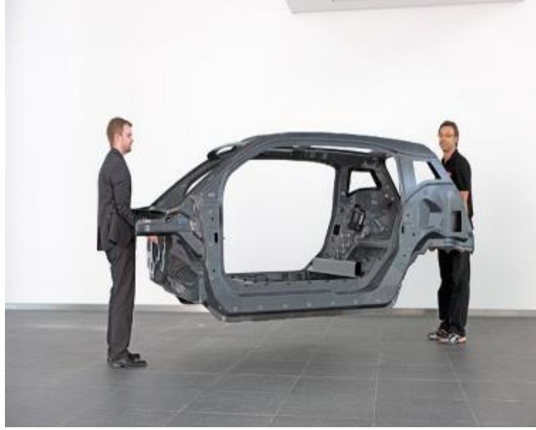
Şekil 2.4. Hafif ve dayanımı yüksek karbon elyafi ile üretilmiş yolcu kabini [10].
