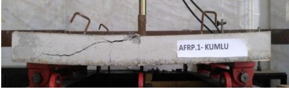
Şekil 4.59. AFRPK donatılı döşeme kırılma sonrası
