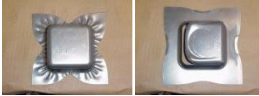
Şekil 4.5. Kare kutu çekme testinde buruşma ve yırtılma [25]
