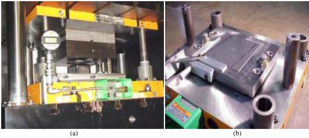
Şekil 4.4. Kare kutu çekme testinde a) servohidrolik pres takımı, b) sacın hizalanması [25]
