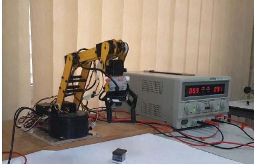
Şekil 2.10. Yosıf'ın gerçekleştirdiği robotik bilgisayar görüşüyle nesne yakalama [23].
