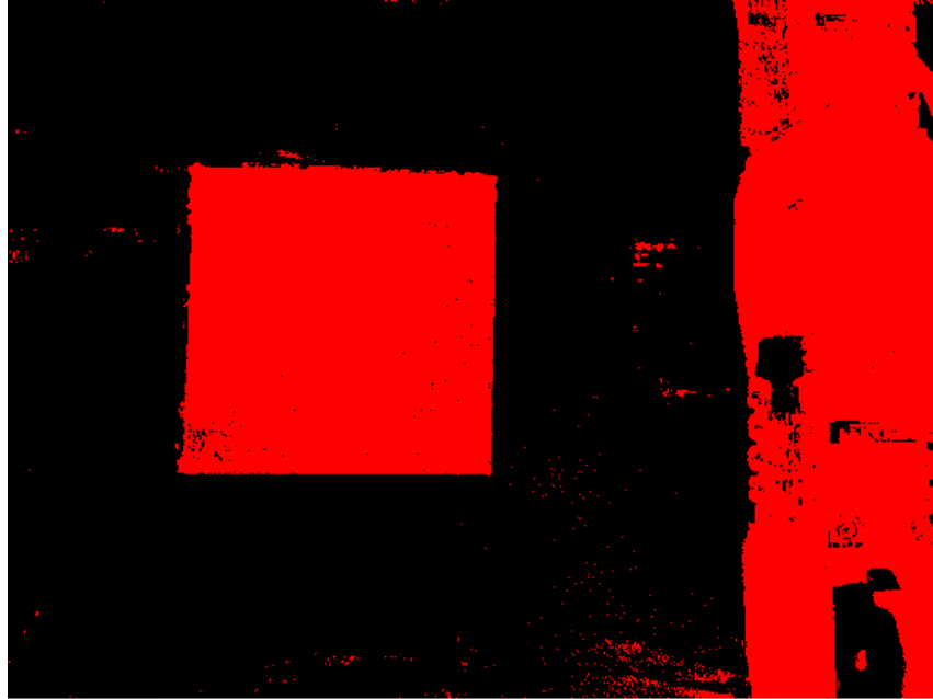
Şekil 6.3. Renk eşiklemesi işlemine tabi tutulan parçanın görüntüsü.
