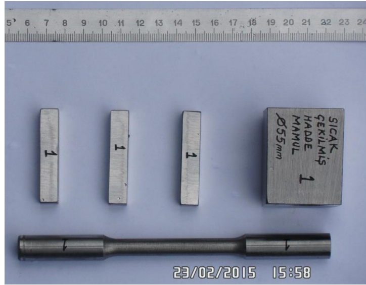
Şekil 4.12. Çekme testi ve çentik testi için hazırlanmış 1 numaralı numuneler
