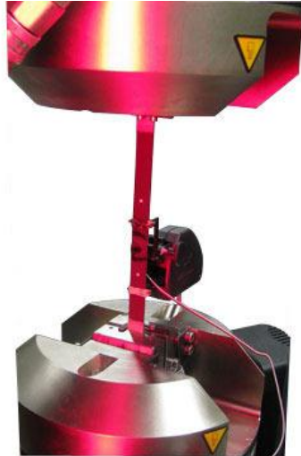
Şekil 3.15. İki çene arasına bağlanmış çekme test numunesi
