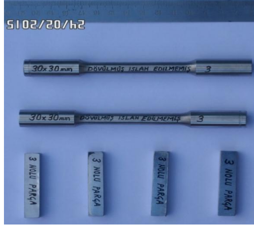
Şekil 4.14. % 63 Oranında redüksiyon yapılmış çekme testi ve çentik testi için hazırlanmış 3 numaralı numuneler
