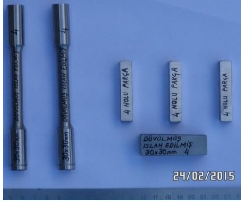
Şekil 4.15. % 63 Oranında redüksiyon ve ısıl işlem yapılmış çekme testi ve çentik testi için hazırlanmış 4 numaralı numuneler
