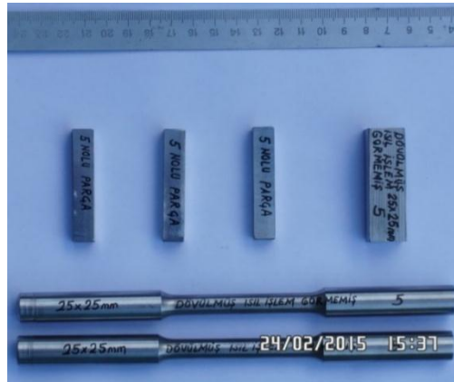
Şekil 4.16. % 74 Oranında redüksiyon yapılmış çekme testi ve çentik testi için hazırlanmış 5 numaralı numuneler
