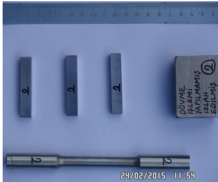
Şekil 4.13. Isıl İşlem Uygulanmış, çekme testi ve çentik testi için hazırlanmış 2 numaralı numuneler
