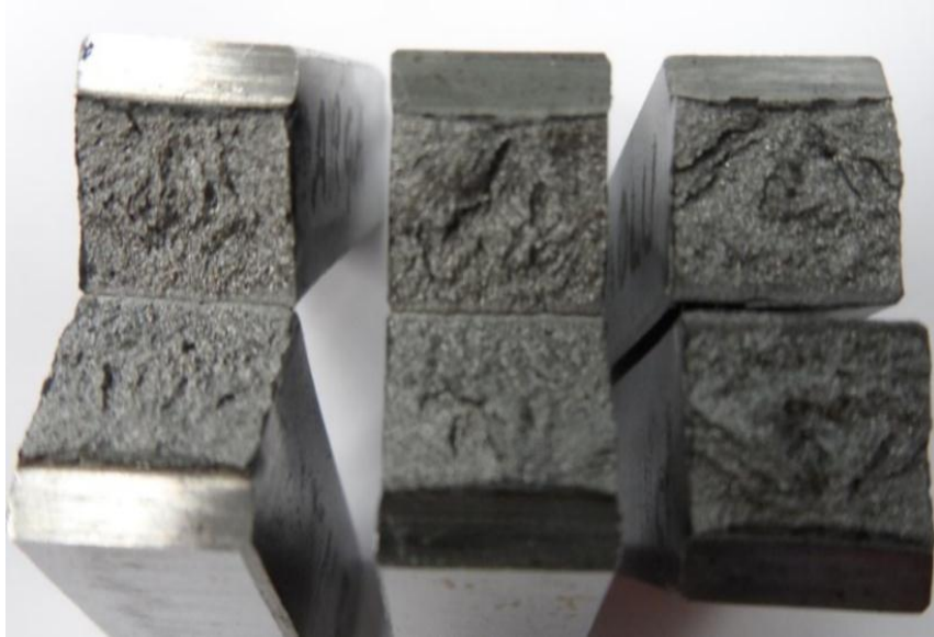
Şekil 4.25. 1 nolu numunenin çentik darbe testinde kırılan parçaları
