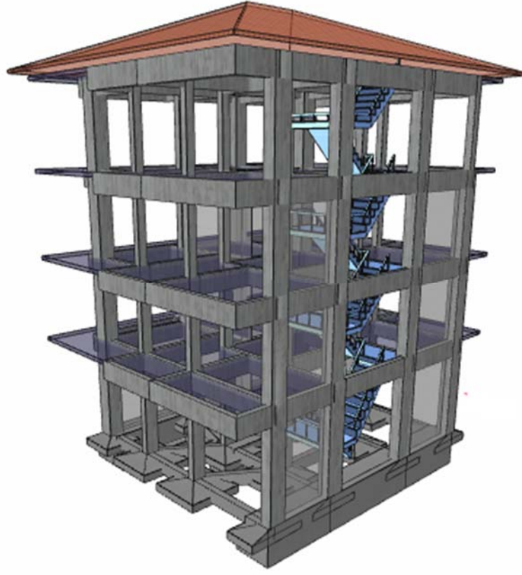
Şekil 5.38. Birinci güçlendirme önerisi 3 boyutlu görünüş
