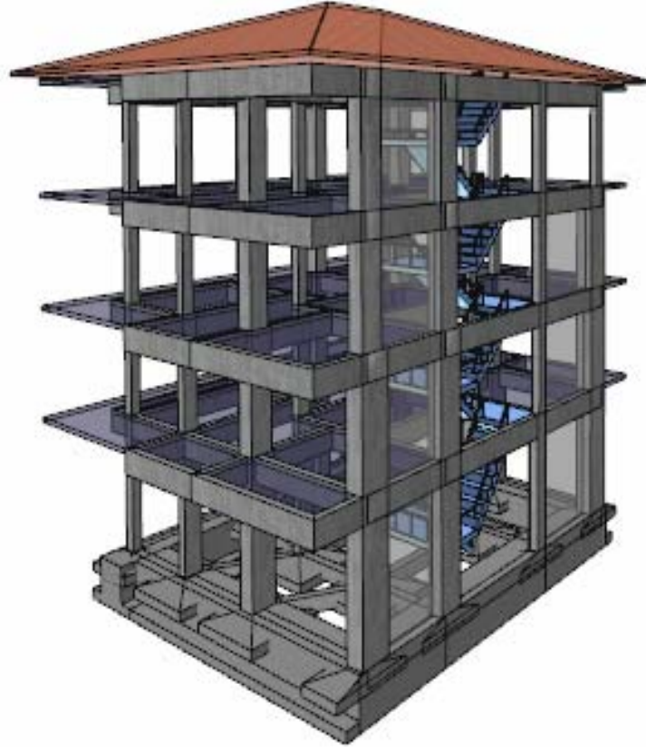
Şekil 5.48. Üçüncü güçlendirme önerisi 3 boyutlu görünüş
