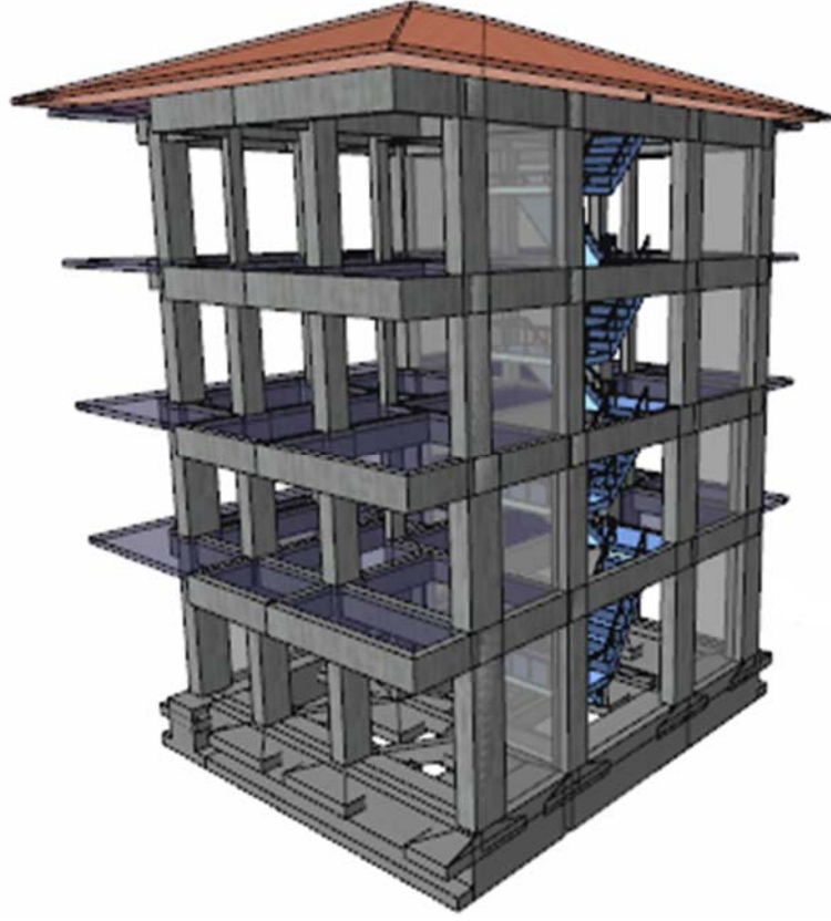
Şekil 5.43. İkinci güçlendirme önerisi 3 boyutlu görünüş
