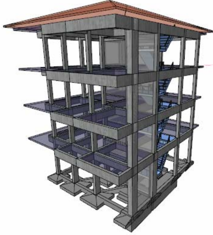
Şekil 5.58. Optimum güçlendirme önerisi 3 boyutlu görünüş
