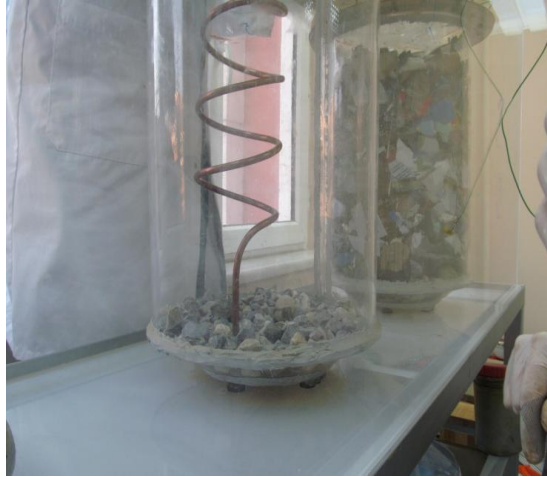
Şekil 6.5. Reaktörlerdeki drenaj tabakası ve havalandırma sistemi
