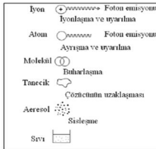
Şekil 5.10. ICP-OES Cihazında uyarılma ve atomlaşmanın şematik gösterimi [16].
