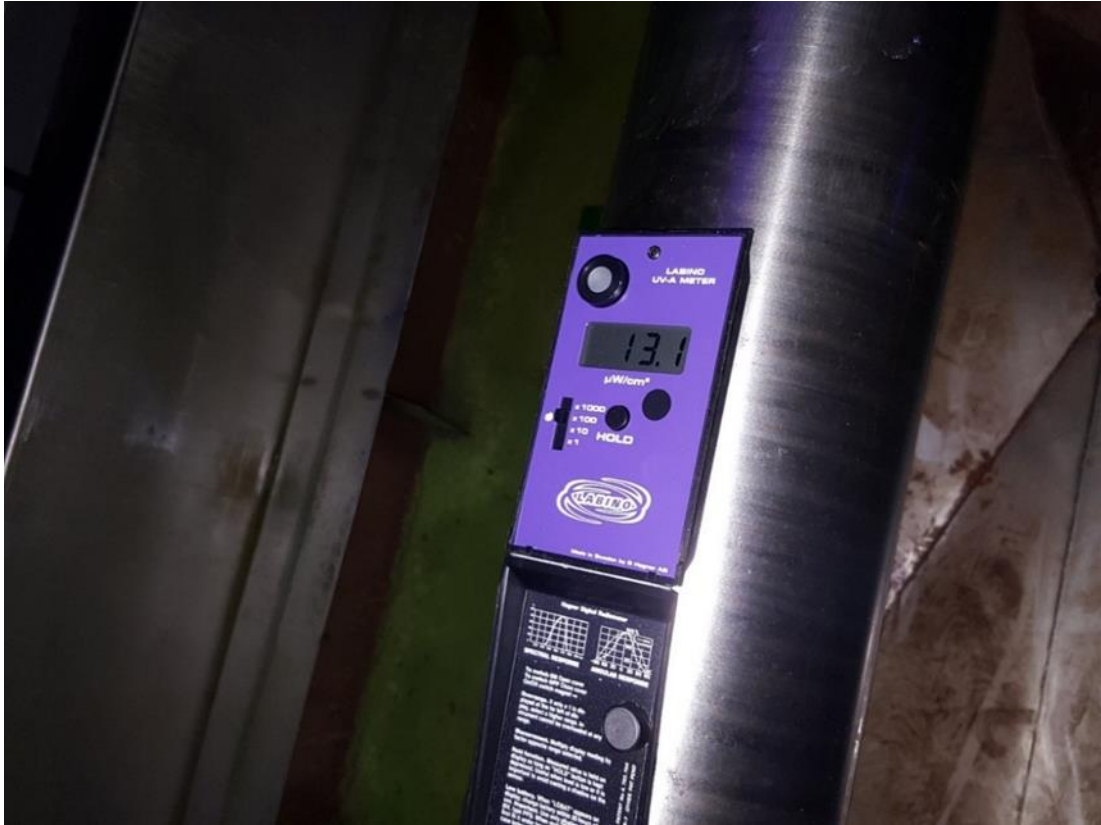
Şekil 5.24.UV ışığın aks üzerine yansıyan UV-A şiddetinin ölçümü.
