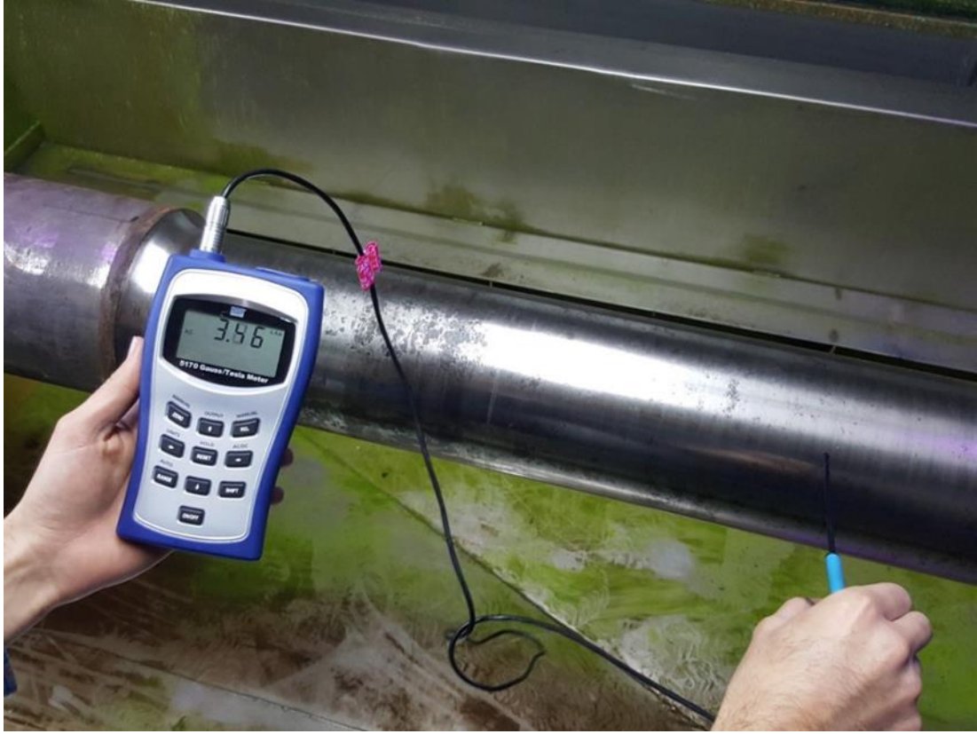
Şekil 5.25. Aks üzerinden geçen teğetsel alan kuvvetinin ölçümü.
