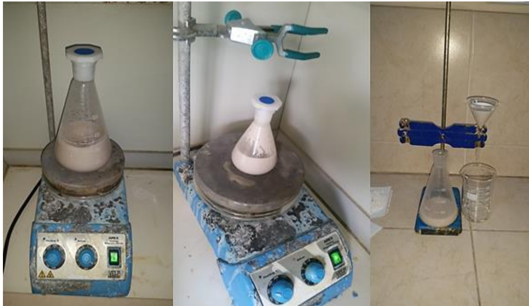
Şekil 4.2.(a,b) Perlit tozundan elde edilen sodyum silikat çözeltisinin karıştırma ve (c) Filtre işlemleri
