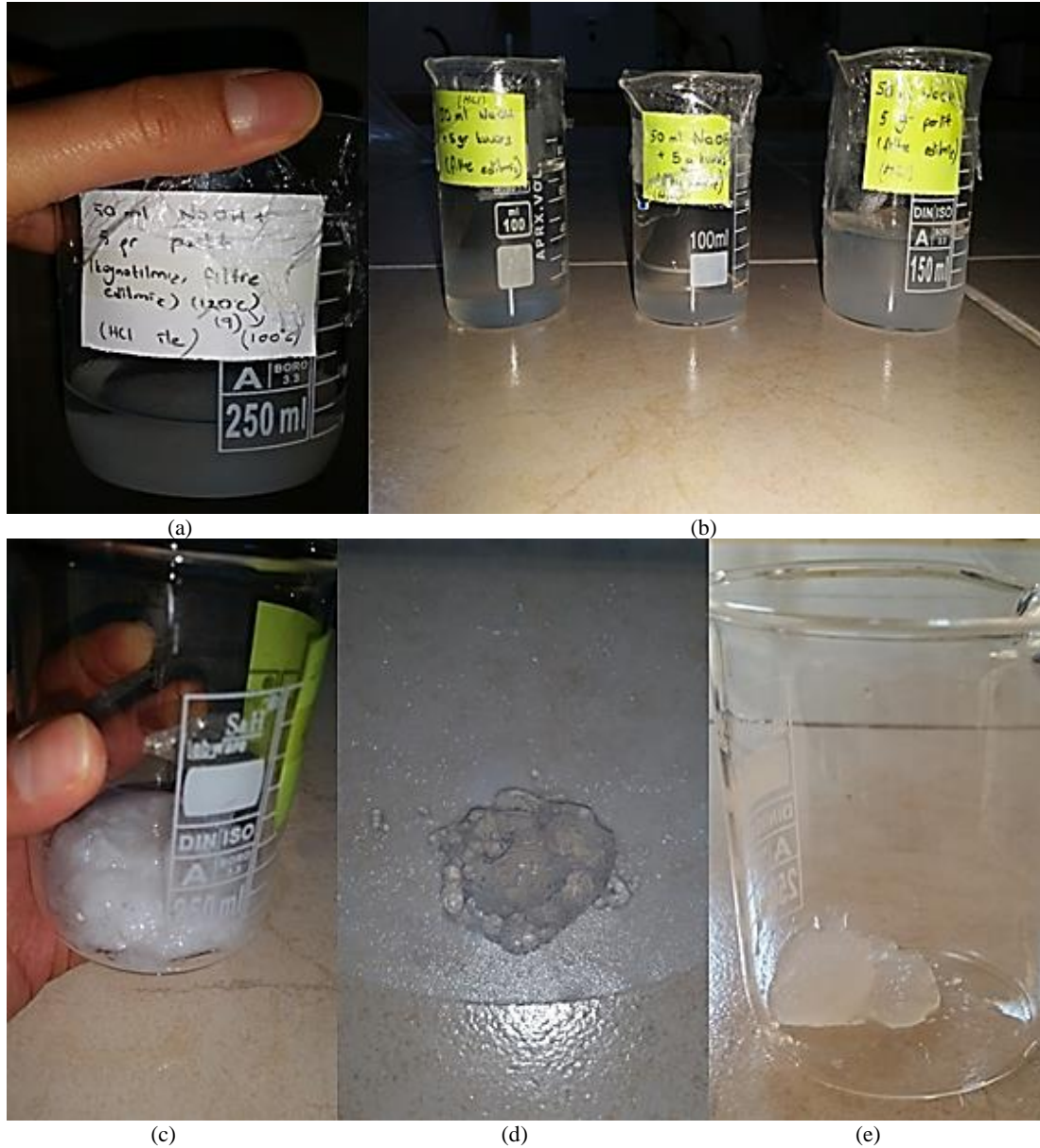
Şekil 4.3. Silika aerogelin oda sıcaklığında (a,b) yaşlandırılması ve (c,d,e) silika jel oluşum aşamaları
