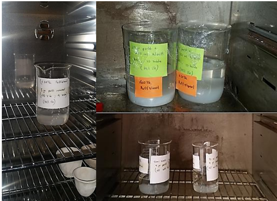
Şekil 4.4. Hazırlanan çözeltilerde etüv içerisinde yaşlandırma işlemi
