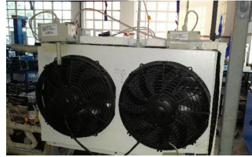
Şekil 4.10. Deneysel otomobil iklimlendirme sisteminde kullanılan sıcaklık/nem ve hava akımı hız sensörlerin montaj resimleri.
