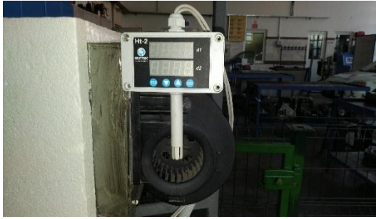
Şekil 4.10. Deneysel otomobil iklimlendirme sisteminde kullanılan sıcaklık/nem ve hava akımı hız sensörlerin montaj resimleri.
