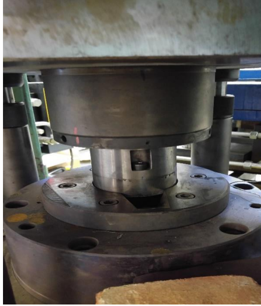
Şekil 3.13. Kalıptaki tahliye penceresi
