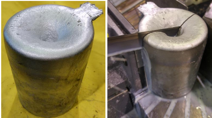
Şekil 3.15. 0 MPa (yer çekimi etkisi) basınç uygulanan parça ve kesimi
