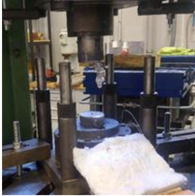
Şekil 3.14. Döküm parçasının katılaştıktan sonra kalıptan çıkarılması
