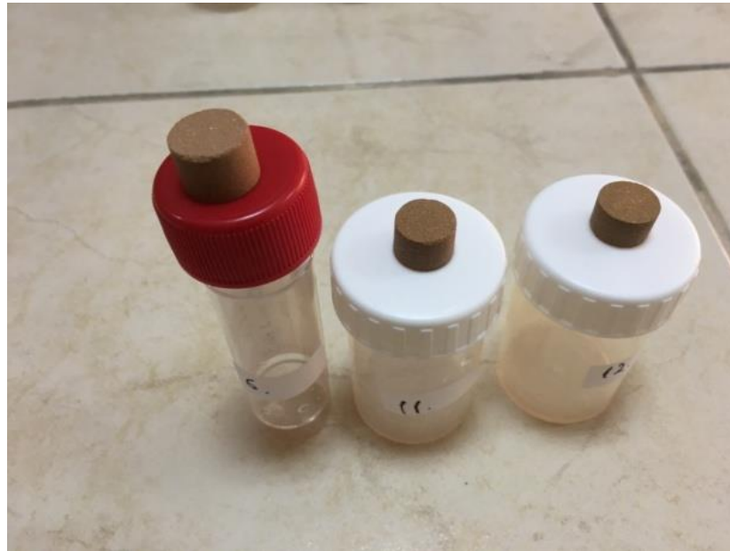
Şekil 6.11.Pamuklaşma testi sonrası zayıf pamuklaşmanın gerçekleştiği numunelerin görüntüsü.
