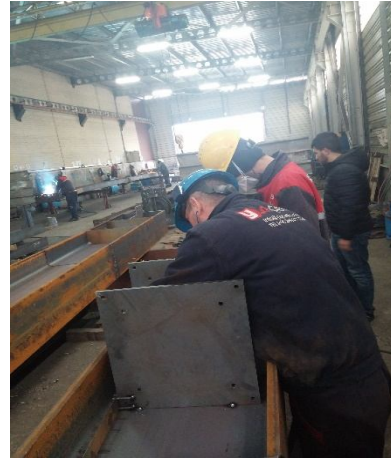
Şekil 3.2. Döşeme mesnet çubuklarının hazırlığı
