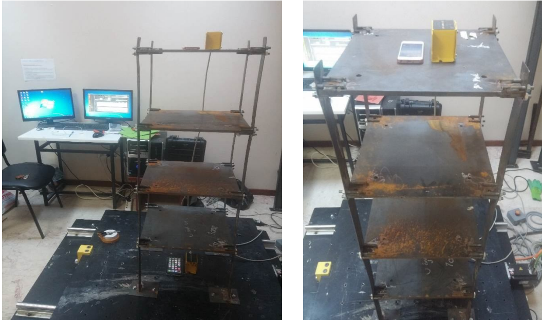
Şekil 3.5. Model yapının enstrümantasyonu
