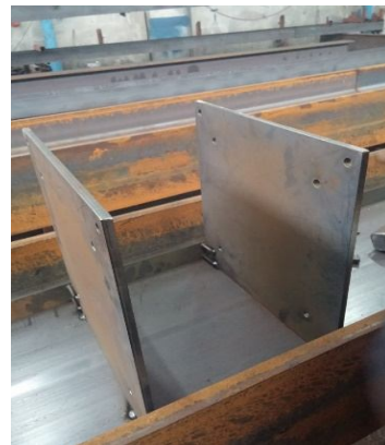
Şekil 3.3. Gerekli ölçülerde kesilip hazırlanmış kolonlar ve döşemeler
