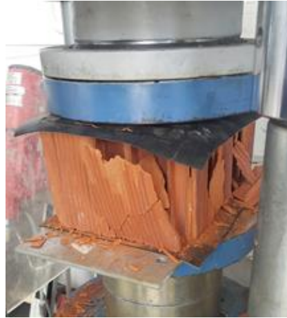
Şekil 3.15. Yığma tuğlanın basınç dayanımının belirlenmesi
