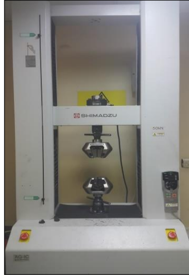
řekil 3.8. Deneylerin gerekleřtirildięi basma-ekme test cihazı
