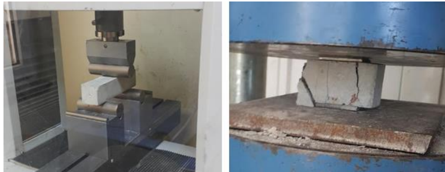
Şekil 3.14. Derz harcının eğilme ve basınç dayanımlarının belirlenmesi
