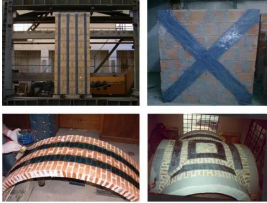
Şekil 2.17. CFRP uygulaması ile güçlendirme [35]
