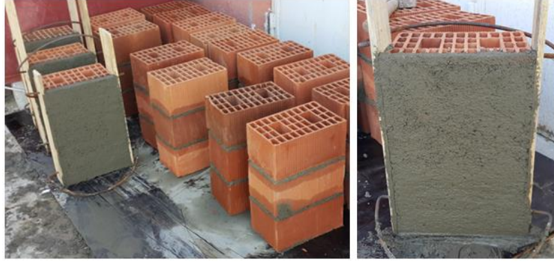
Şekil 3.3. Kum sıvalı numunelerin hazırlanması
