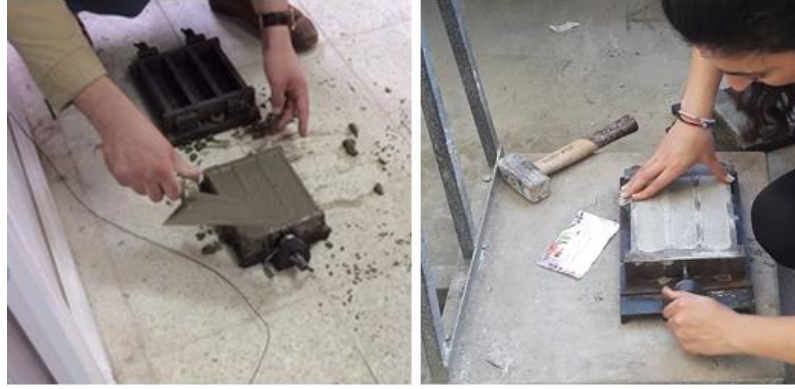
Şekil 3.13. Harç eğilme ve basınç dayanımının belirlenmesi için numunelerin hazırlanması
