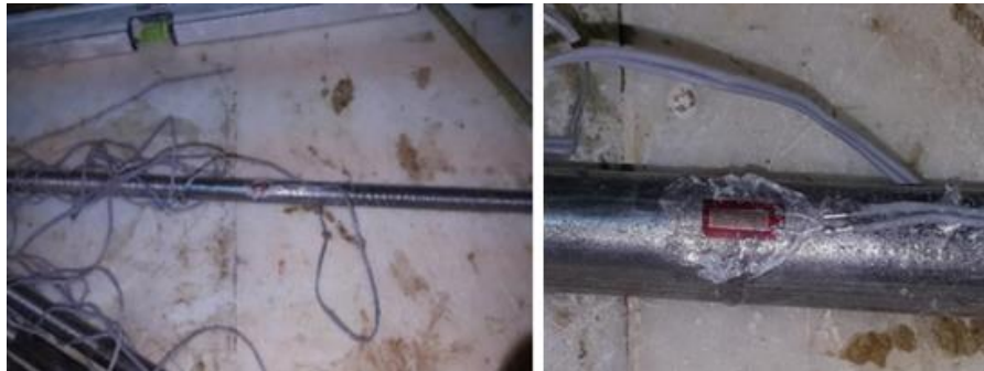
Şekil 3.12. Deney II grubuna ait testlerde kullanılan gerinim ölçerler
