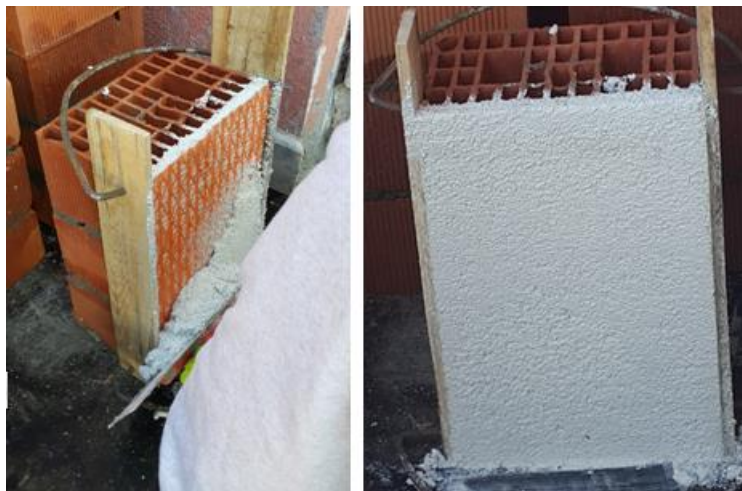
Şekil 3.7. Tip T sıva vasıtasıyla güçlendirilen numunelerin hazırlanması
