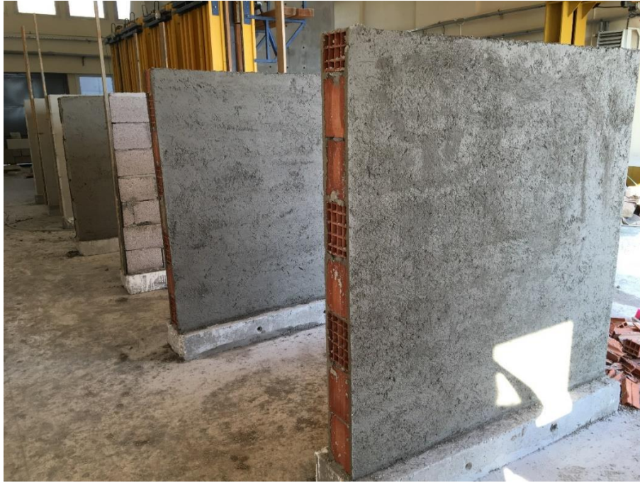
Şekil 3.5. Deneye hazırlanan dolgu duvar numuneleri
