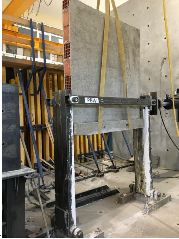
Şekil 3.6. Hazırlanan dolgu duvarların deney düzeneğine yerleştirilmesi
