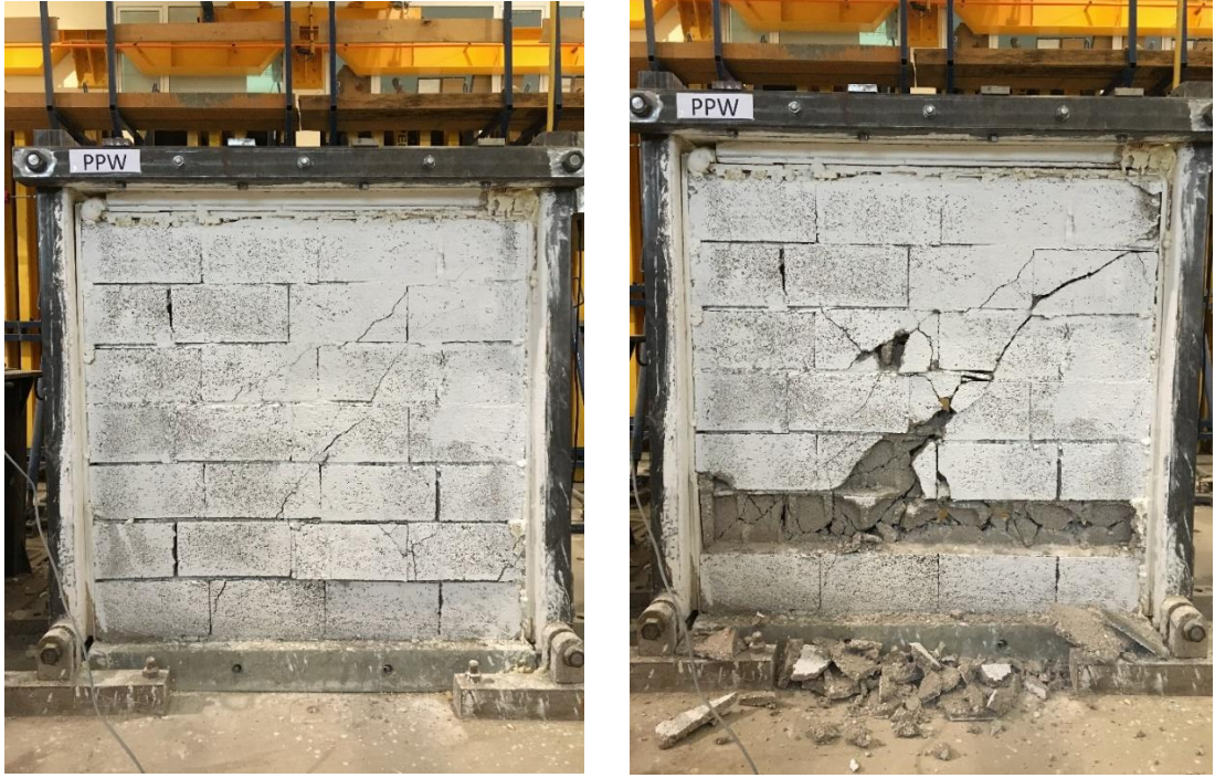
Şekil 4.24. PPW dolgu duvarının deney anı görüntüleri
