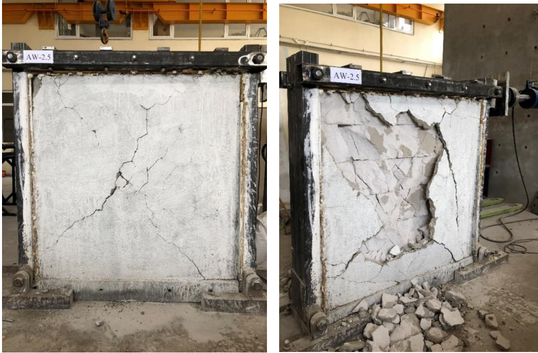
Şekil 4.54. AW-2.5 dolgu duvarının deney sırasında görüntüleri
