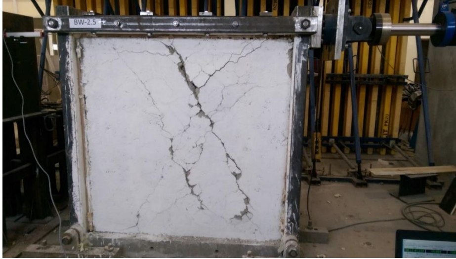
Şekil 4.13. BW-2.5 dolgu duvarının deney anı görüntüsü
