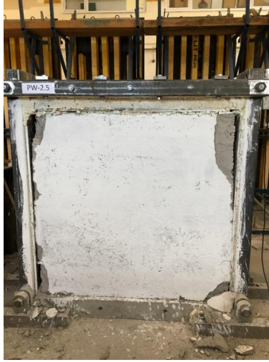
Şekil 4.38. PW-2.5 dolgu duvarının deneyler sırasında görüntüsü
