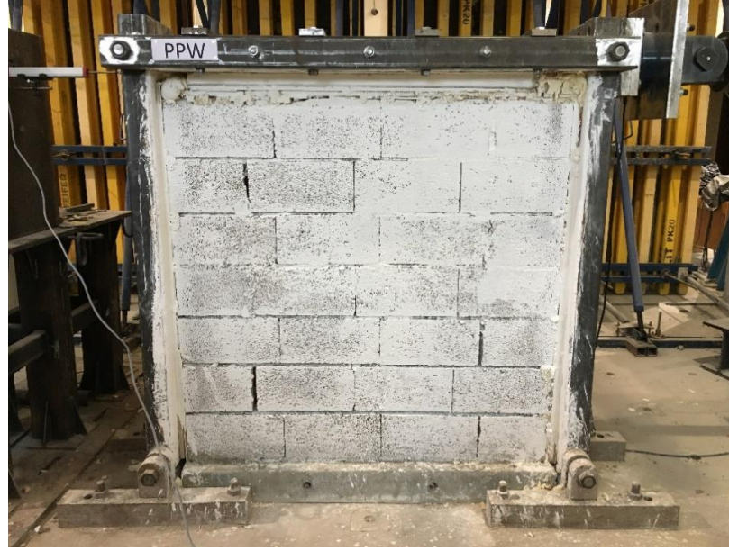
Şekil 4.19. PPW dolgu duvarının deney başlangıcı görüntüsü
