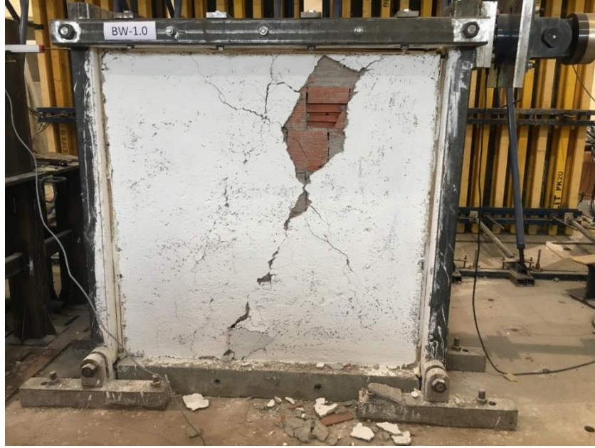
Şekil 4.7. BW-1.0 dolgu duvarının deneyler sırasında görüntüsü
