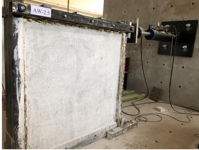
Şekil 4.51. AW-2.5 dolgu duvarının deney başlangıcı görüntüsü
