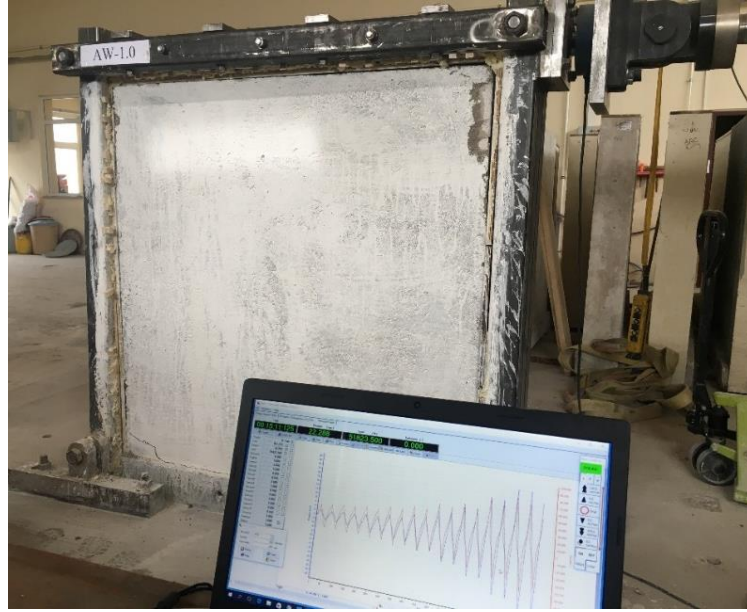
Şekil 4.45. AW-1.0 dolgu duvarının deney başlangıcı görüntüsü
