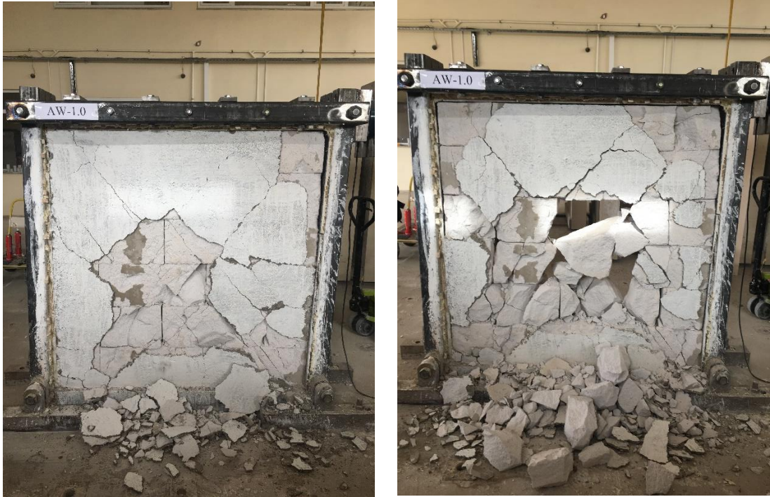
Şekil 4.50. AW-1.0 dolgu duvarının deney sonu görüntüleri
