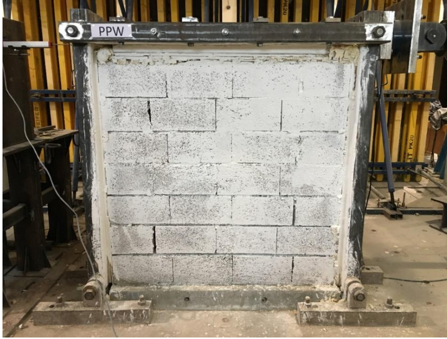
Şekil 3.2. Bims bloklar kullanılarak üretilen dolgu duvar
