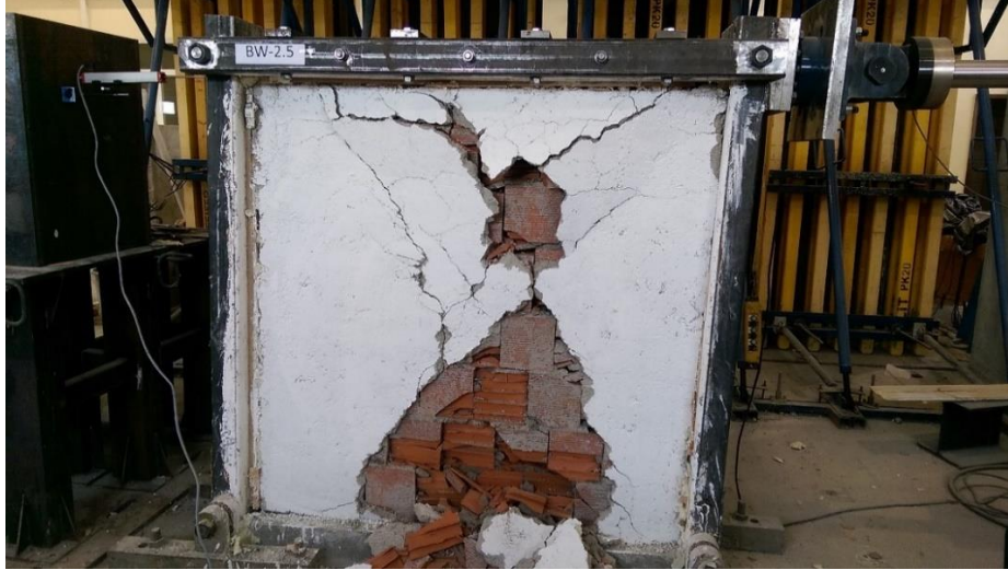
Şekil 4.18. BW-2.5 dolgu duvarının deneyler sırasında görüntüsü
