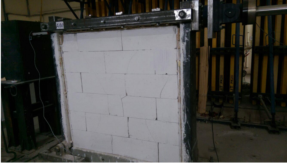
Şekil 3.3. Gazbeton bloklar kullanılarak üretilen dolgu duvar
