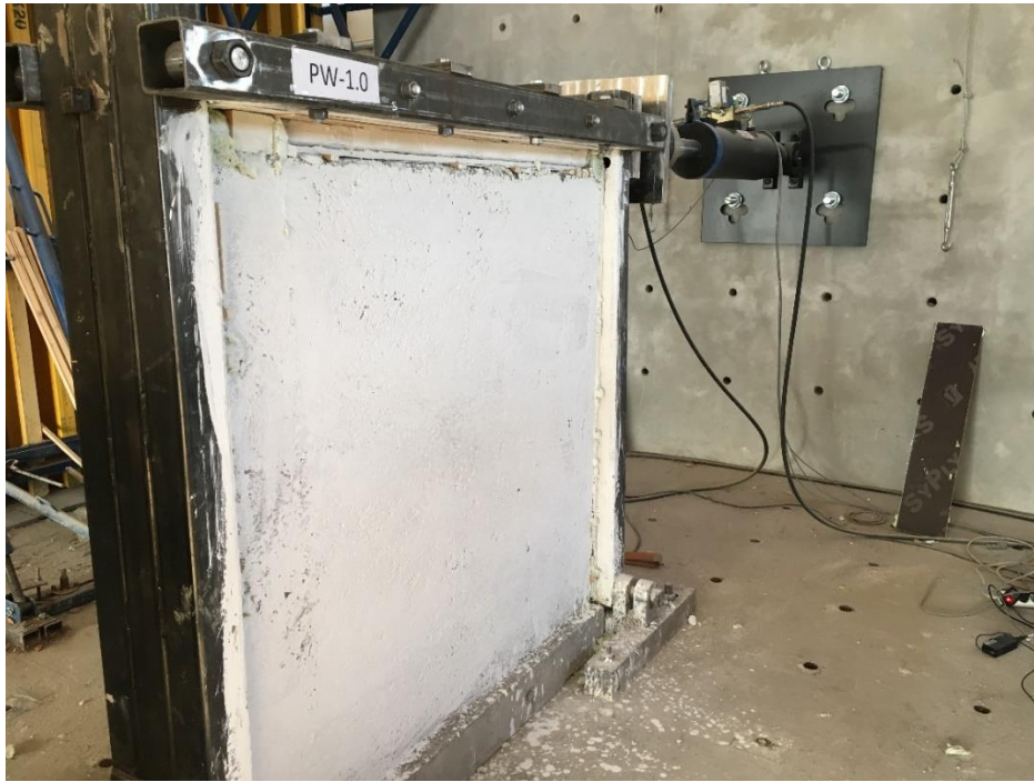
Şekil 4.26. PW-1.0 dolgu duvarının deney başlangıcı görüntüsü
