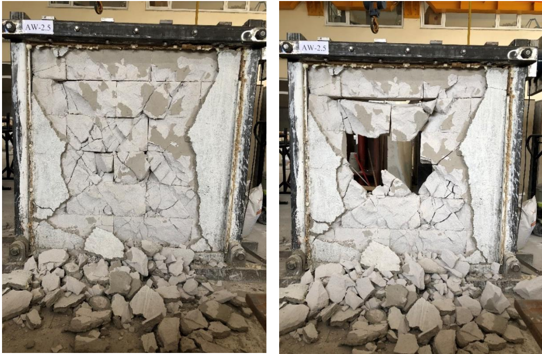
Şekil 4.57. AW-2.5 dolgu duvarının deney sonu görüntüleri
