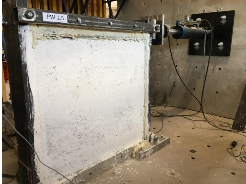
Şekil 4.33. PW-2.5 dolgu duvarının deney başlangıcı görüntüsü
