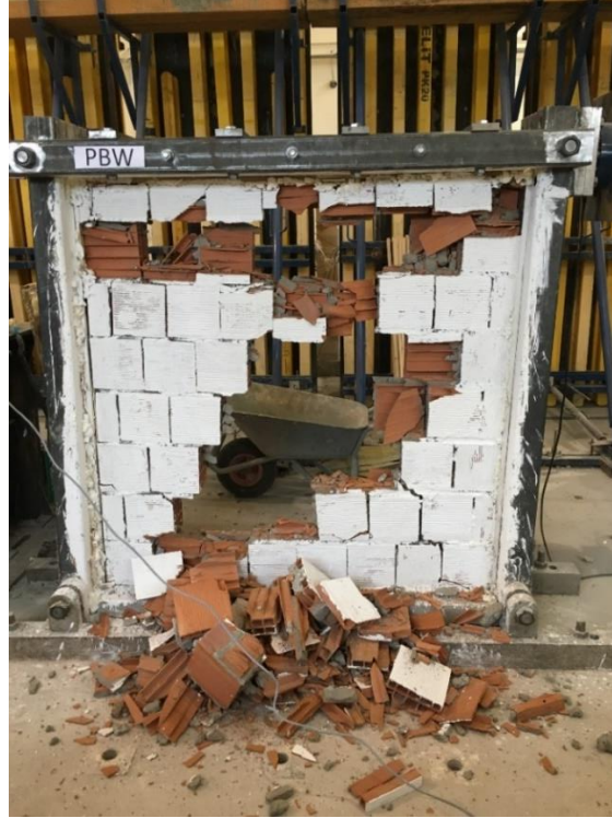
Şekil 4.6. PBW dolgu duvarının deney sonu görüntüsü
