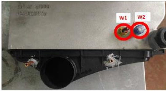
W2 Noktası (Yüzey Tip NTC Sensörü)
