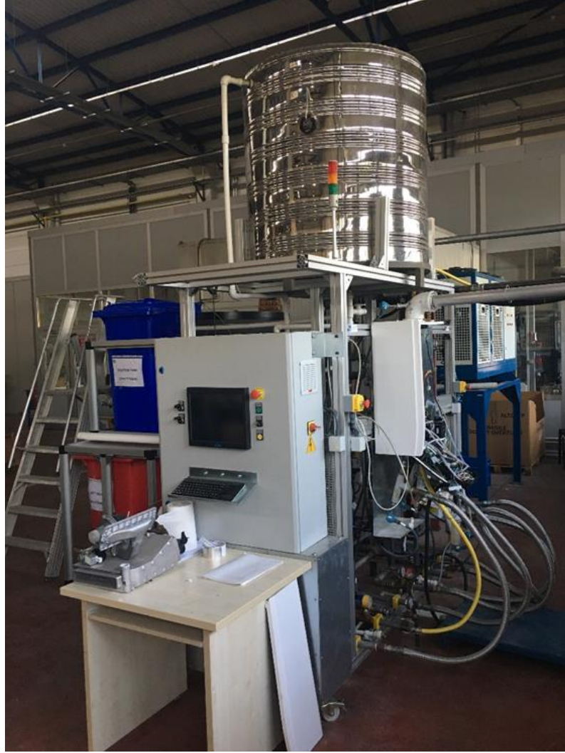
Şekil 3.2. Daikin Arge Merkezi Kireçlendirme Test Standı ®
