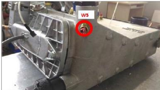
Şekil 4.13. Su Tarafı ve Eşanjör Yüzeyi Sıcaklık Değerlerinin NTC Sensörlerle Ölçülmesi.
