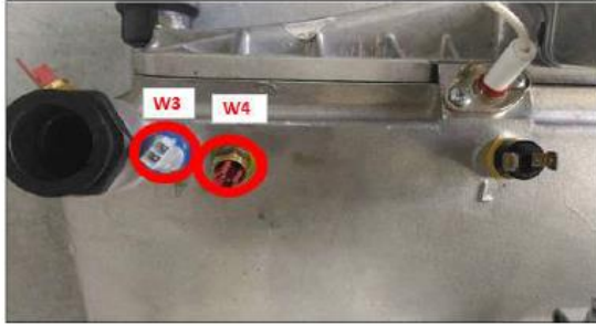
Şekil 4.12. Su Tarafı ve Eşanjör Yüzeyi Sıcaklık Değerlerinin NTC Sensörlerle Ölçülmesi.
