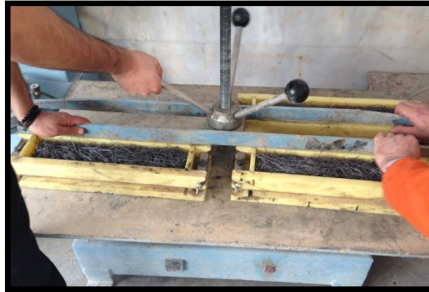
Şekil 4.23. Lifler yerleştirilmiş kalıpların sarsma makinesine yerleştirilmesi
