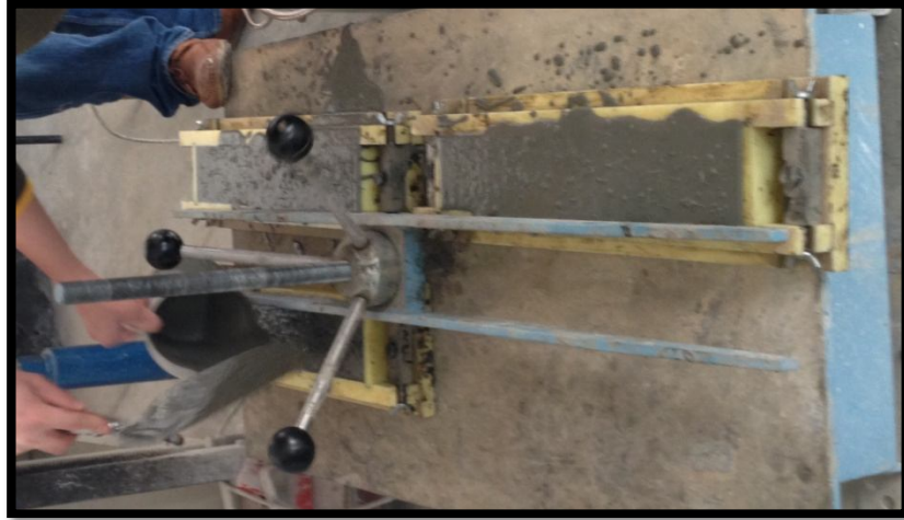
Şekil 4.24. Lifler yerleştirilmiş kalıpların sarsma makinesinde betonun dökülmesi
