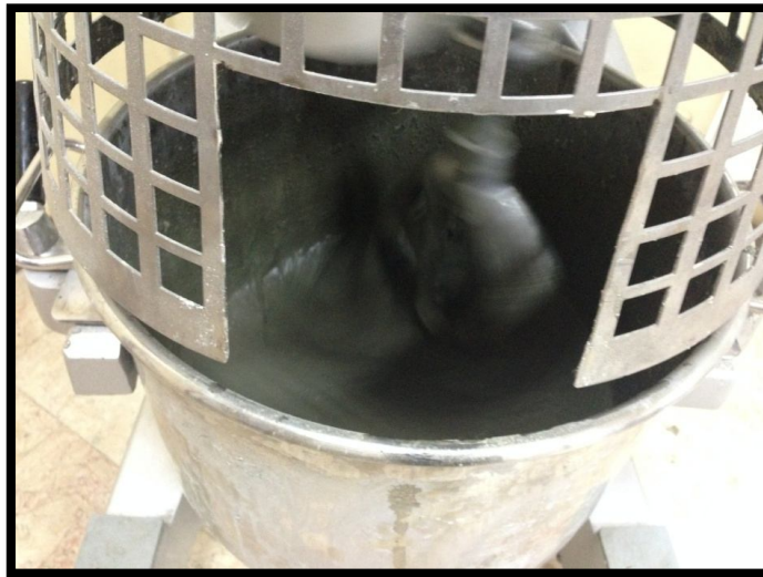
Şekil 4.19. SIFCON için hazırlanmış malzeme karışımı
