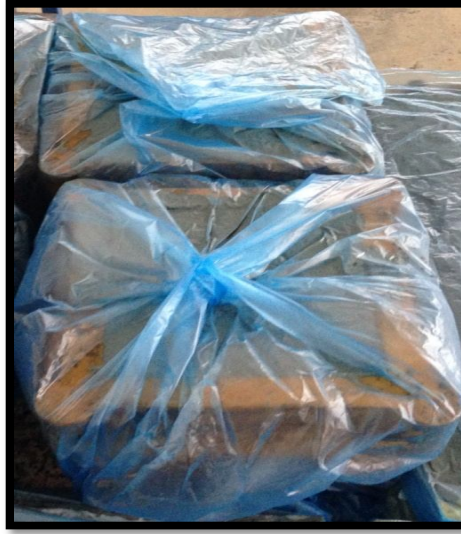
Şekil 4.26. SİFCON küplerin poşetlenmesi
