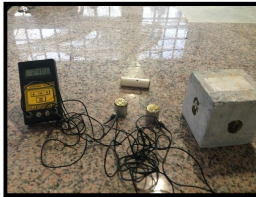
Şekil 4.39. Ultrases geçiş hızı deneyi numunenin ölçüme hazırlanması
