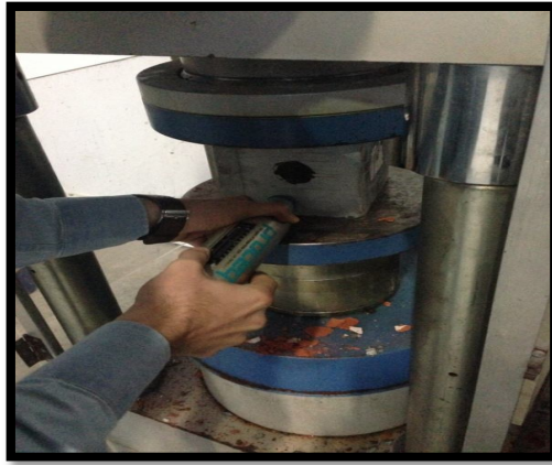
Şekil 4.44. Schmidt çekici numuneye uygulanması
