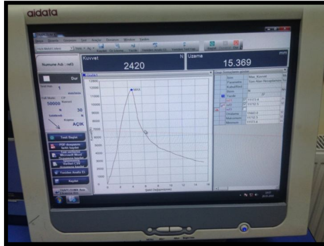
Şekil 4.36. Eğilme deneyi ölçüm görüntüsü
