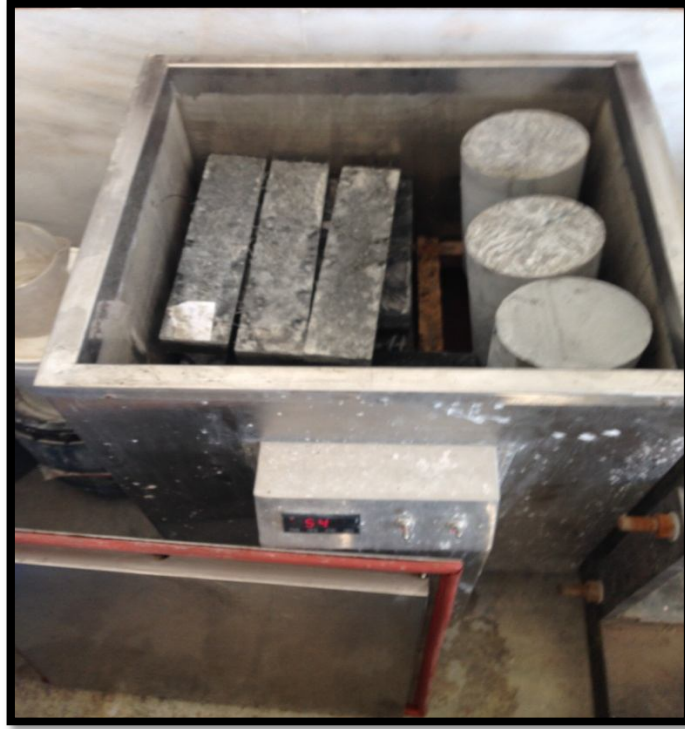
Şekil 4.28. SİFCON numunelerinin buhar kürüne yerleştirilmesi
