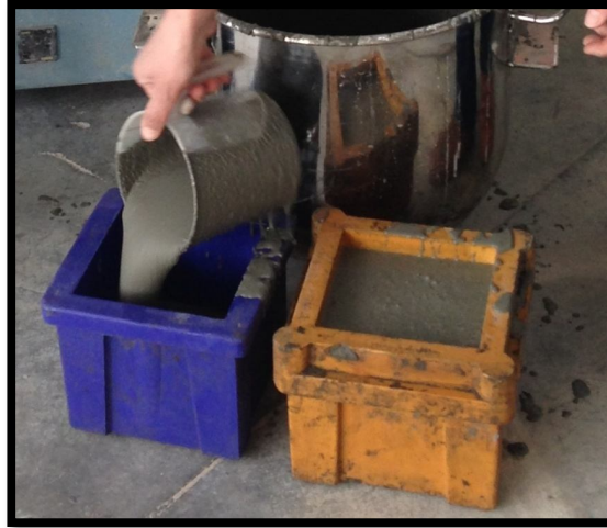
Şekil 4.21. SİFCON kalıplara doldurulması
