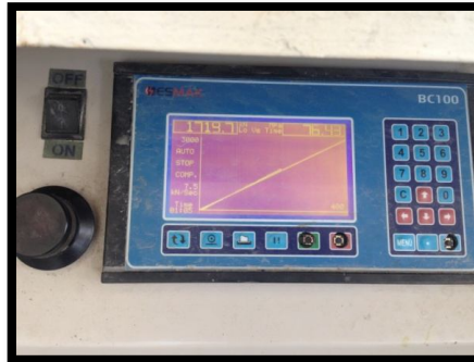
Şekil 4.33. Beton basınç dayanımı ölçüm görüntüsü
