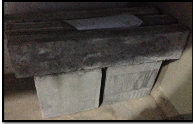
Şekil 4.30. SIFCON numunelerin deneyler için kurumaya bırakılması
