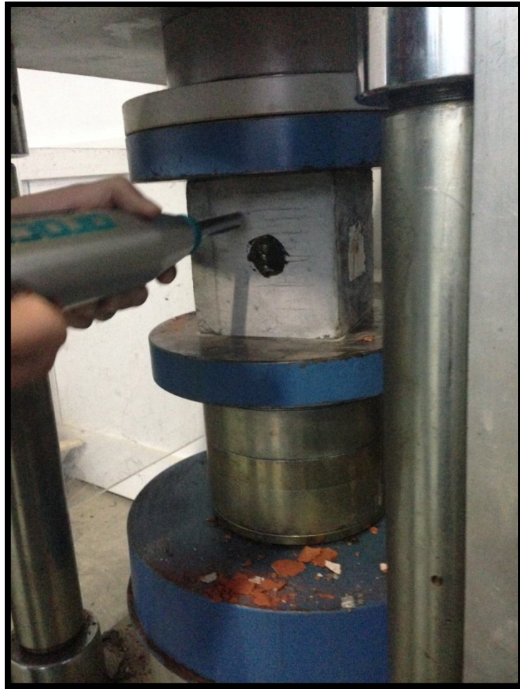
Şekil 5.16. Schmidt çekici deneyi numuneye uygulanması
