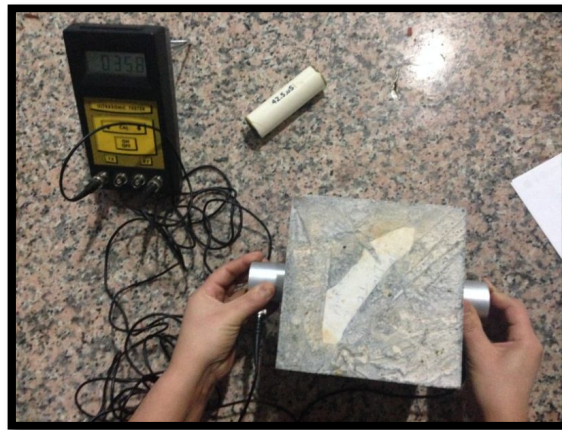
Şekil 5.9. Ultrases geçiş hızı numuneye uygulanması
