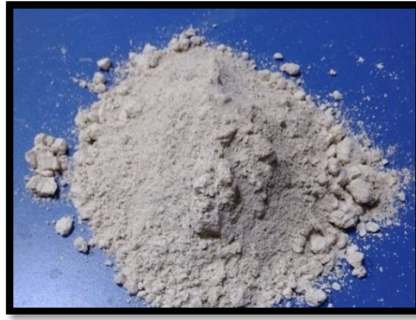
Şekil 4.11. Kullanılan taş tozu malzemesi
