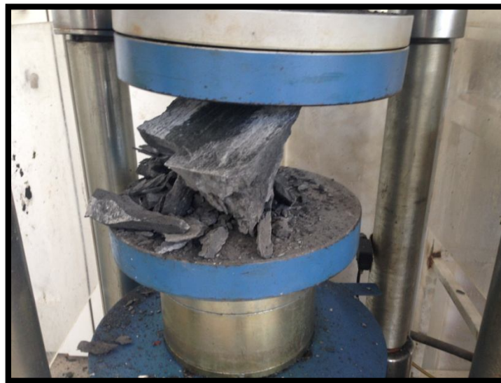
Şekil 5.3. Basınç dayanımı numunenin deney uygulama sonrası kırılma şekli
