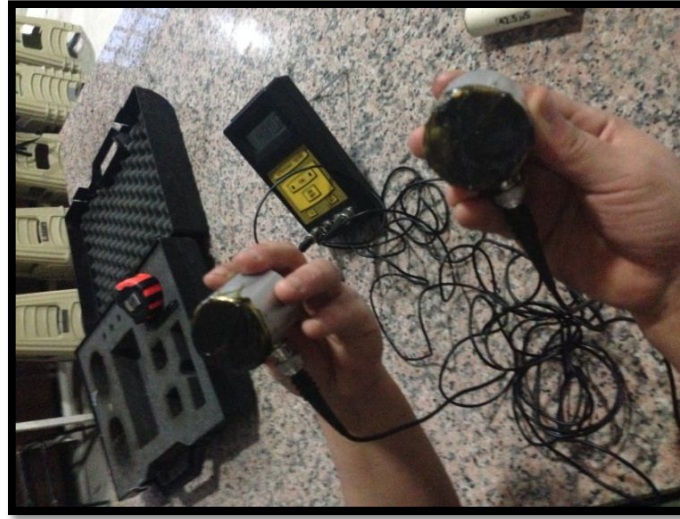
Şekil 4.41. Ultrases geçiş hızı deneyi problara gres yağı sürülmesi
