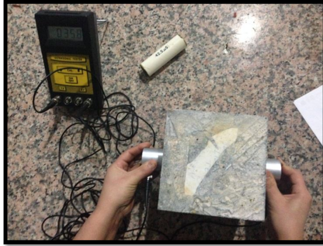
Şekil 4.42. Ultrases geçiş hızı deneyi problarla deneyin uygulanması
