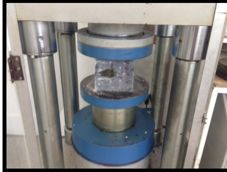
Şekil 4.32. Beton basınç dayanımı deneyi
