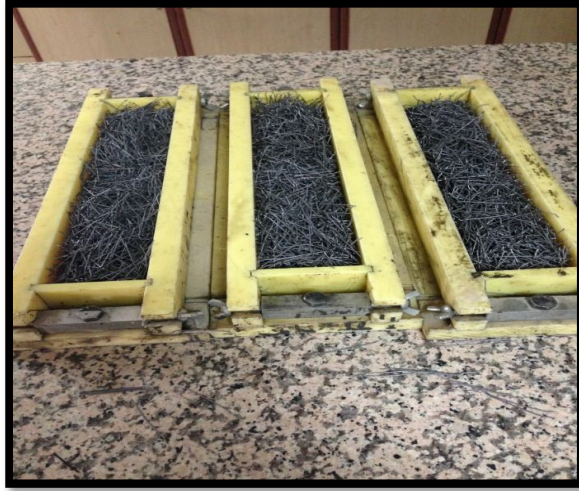
Şekil 4.22. Liflerin kalıba doldurulması
