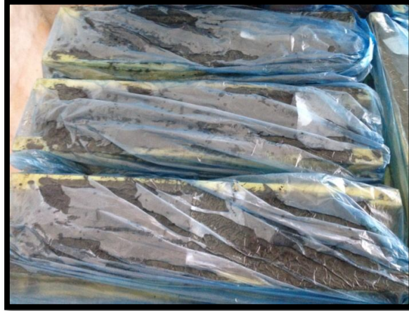
Şekil 4.25. SİFCON kirişlerin poşetlenmesi
