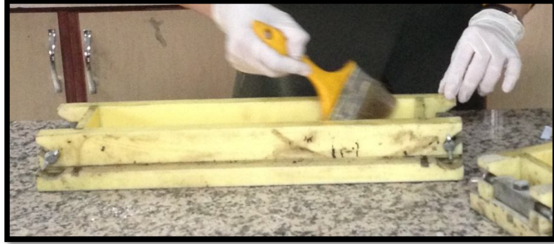
Şekil 4.20. Liflerin yerleştirileceği kalıbın yağlanması
