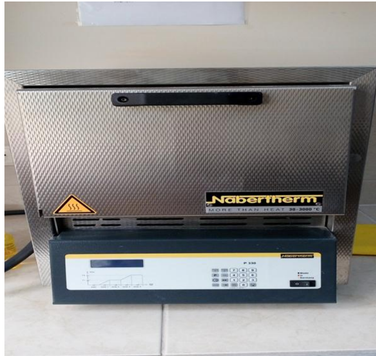
Şekil 4.4. Kalsinasyonun gerçekleştiği Nabertherm markalı ısıtma fırını
