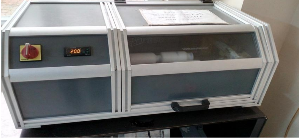
Şekil 4.2. Tozların karıştırılmasında kullanılan MSE markalı karıştırıcı (ball milling)
