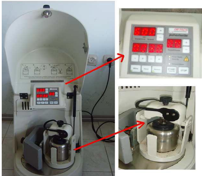
Şekil 4.5. Mekanik Aktivasyon işlemi için kullanılan gezegensel değirmen [26].
