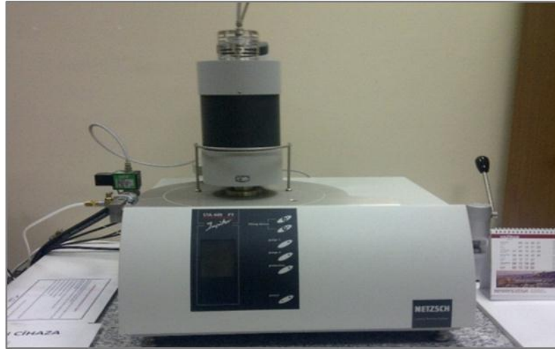
Şekil 4.11. Deneysel çalışmalarda kullanılan Netzsch marka DTA/TG analiz cihazı
