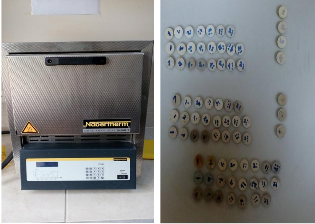
Şekil 4.9. (a) Sinterlemenin gerçekleştiği ısıtım fırını, (b) Sinterleme olmuş numunelerin makro görüntüsü
