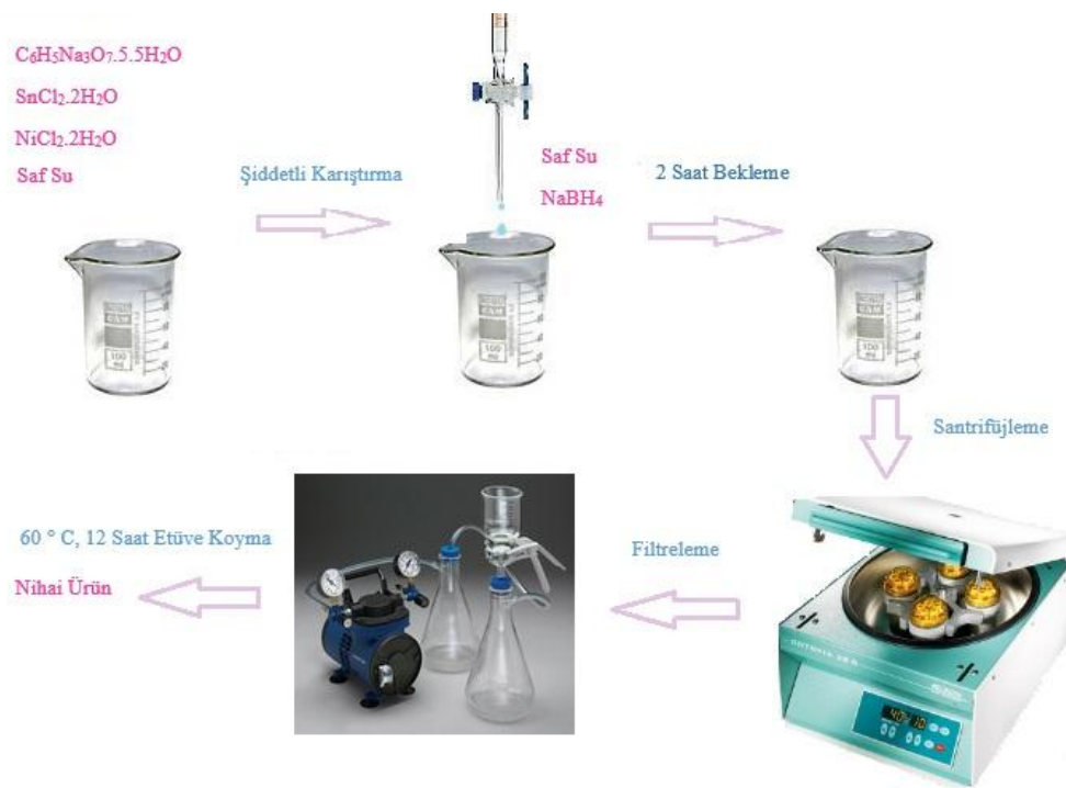
Şekil 4.2. \text{Ni}_3\text{Sn}_4 intermetalik nano tozlarının üretim şeması.
