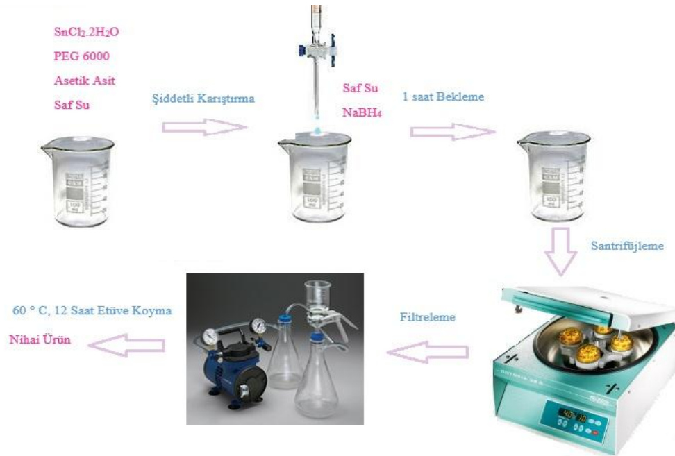
Şekil 4.1. Sn nano tozlarının üretim şeması.
