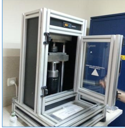
Şekil 5.6. Silindirik numunelerin üretiminde kullanılan pres.
