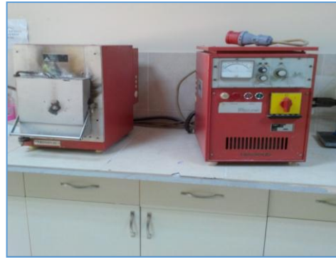
Şekil 5.3. Cam ergitme fırını.
