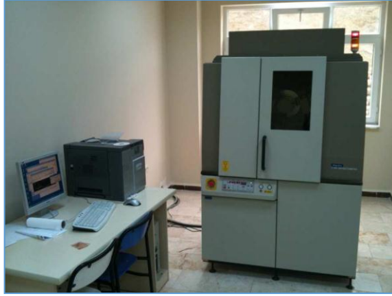
Şekil 5.7. X - ışını difraksiyon analiz cihazı.
