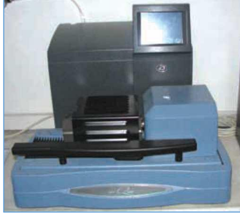
Şekil 5.5. Termal analizlerde kullanılan DTA cihazı
