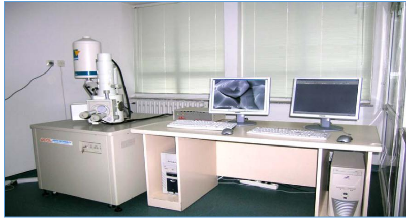
Şekil 5.8. Taramalı elektron mikroskobu (SEM).
