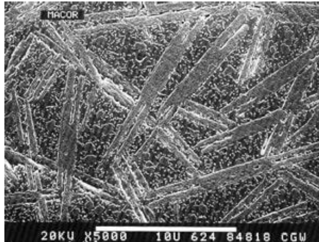
Şekil 4.1. Macor'a ait mikroyapı görüntüsü [54]
