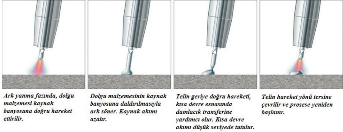
Şekil 5.1. CMT yönteminin aşamaları [35].
