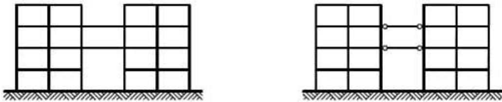
Şekil 2.21. İki yapıyı birleştiren elemanlarda moment aktaran ve aktarmayan bileşimler (Celep ve Kumbasar, 2004).
