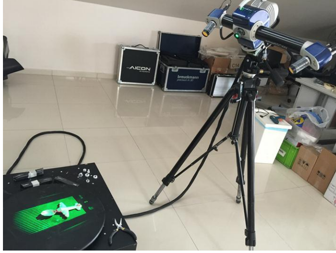
Şekil 5.3. Smartscan model optik tarayıcı ile parçanın taraması
