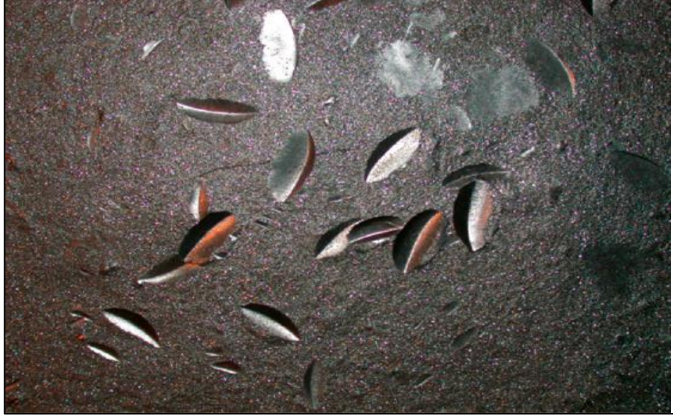
Şekil 2.13. Bir Ti_2AlC bloğunun yüzeyinin bir çelik çekiçe defalarca çarptıktan sonraki görüntüsü [26].
