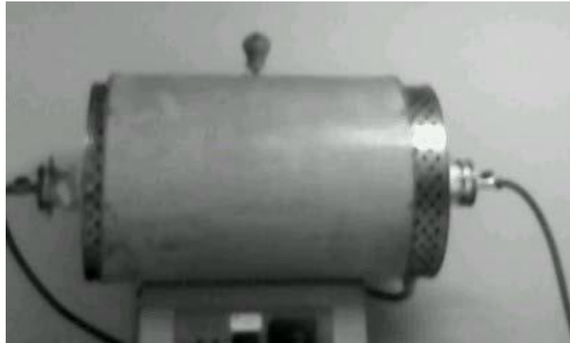
Şekil 3.14. Çalışmalarda kullanılan Protherm marka atmosfer kontrollü yatay tüp fırını.
