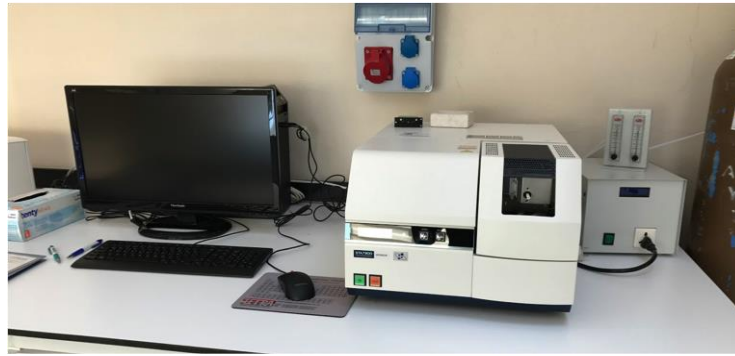
Şekil 3.10. DTA analizlerinin yapıldığı termal analiz cihazı.
