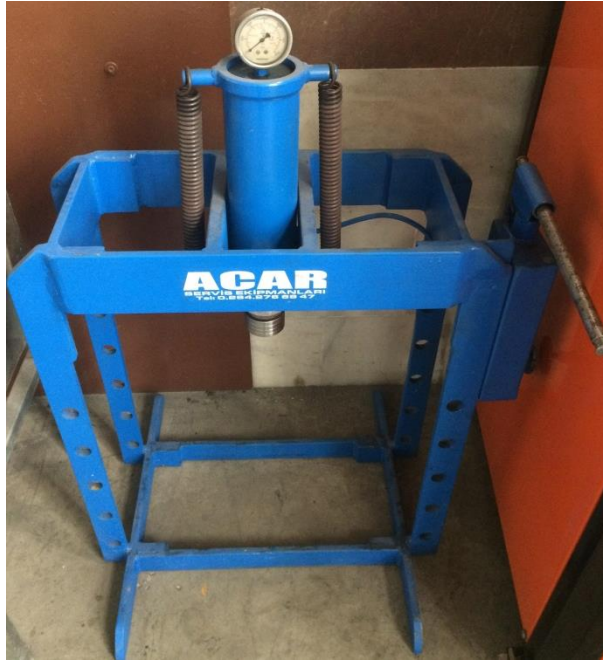
Şekil 3.7. Kullanılan tek eksenli hidrolik pres
