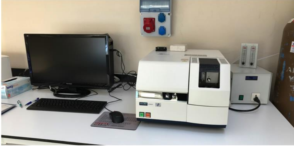
Şekil 3.10. Termal analizlerin yapıldığı TD-DTA cihazı
