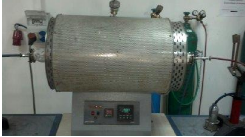
Şekil 3.8. Basıncısız Sinterleme işleminde kullanılan dikey tüp fırın
