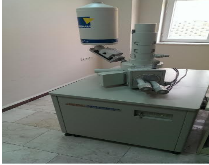
Şekil 3.14. Mikro yapı görüntülerinin çekildiği taramalı elektron mikroskobu
