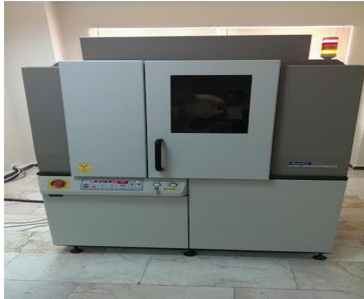
Şekil 3.12. XRD analizlerinin yapıldığı X-ışıını difraksiyonu cihazı
