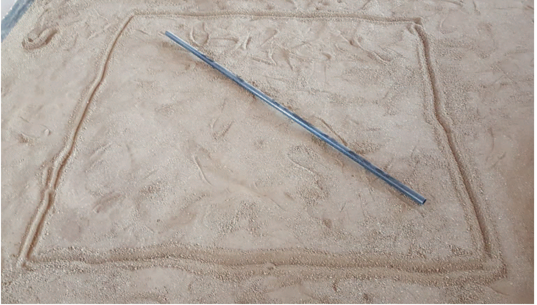
Şekil 3.23. 2m x 2m test alanı metal boru
