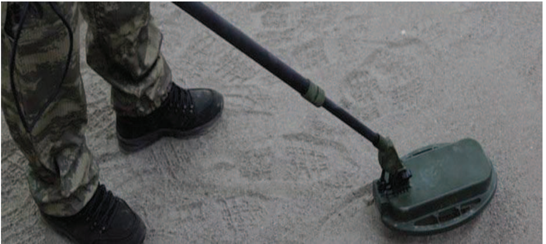
Şekil 3.4. Tübitak ETMTS-2 araştırma bobini [15].
