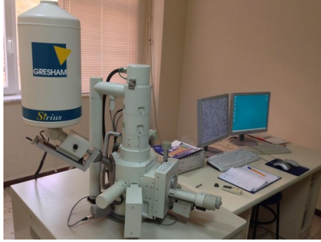
Şekil 4.10. Mikroyapı incelemelerinde kullanılan taramalı elektron mikroskobu (SEM)
