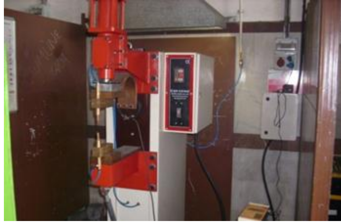
Şekil 4.3. Deneylerde kullanılan elektrik direnç nokta kaynağı makinesi
