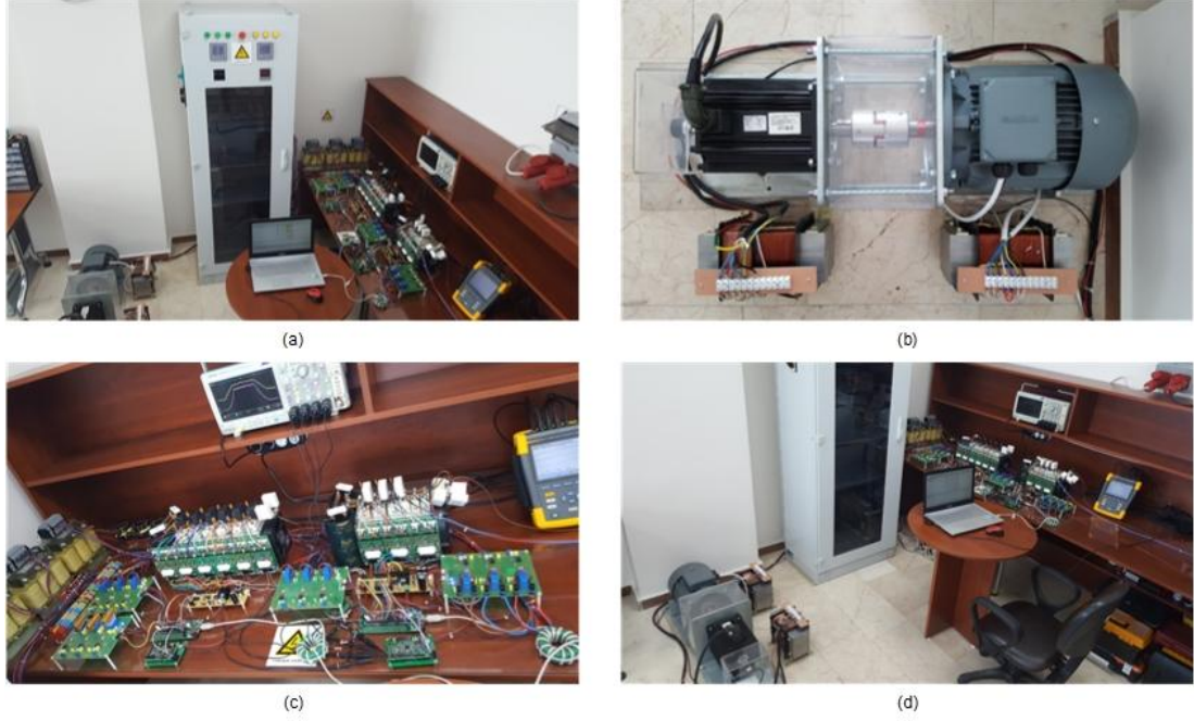
Şekil 7.12. Deneysel düzeneğin resimleri (a) tüm donanım (b) motor- generatör ve ortak durum filtreleri (c) güç dönüştürücüler ve filtreler (d) tüm donanım
