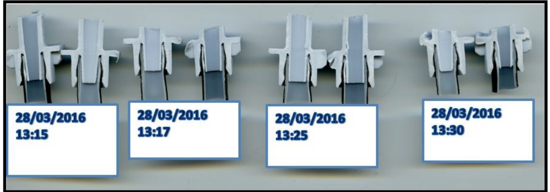
Şekil 4.6. Enine kesit alınmış numuneler
