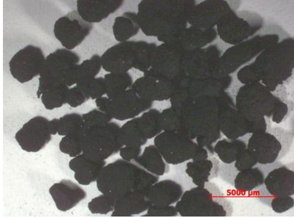
Şekil 5.9. Hazırlanan Al(OH) 3 +C karışımlarından elde edilen granüller.
