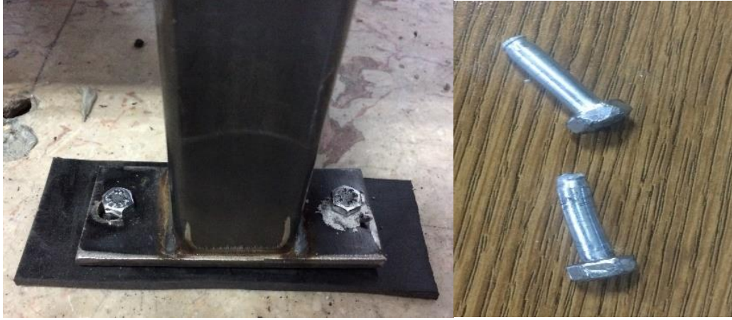
Şekil 4.12. a) ayakların sabitlendiği metrik 6 vidalar b) kesilmiş metrik 6 vidalar
