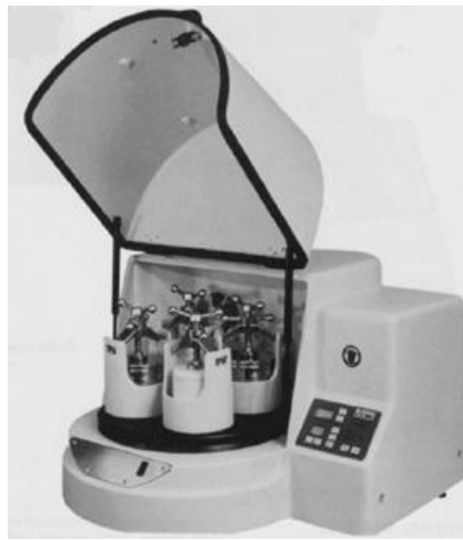
Şekil 3.2. Gezegen tipi öğütücü (Suryaranayana, 2001).
