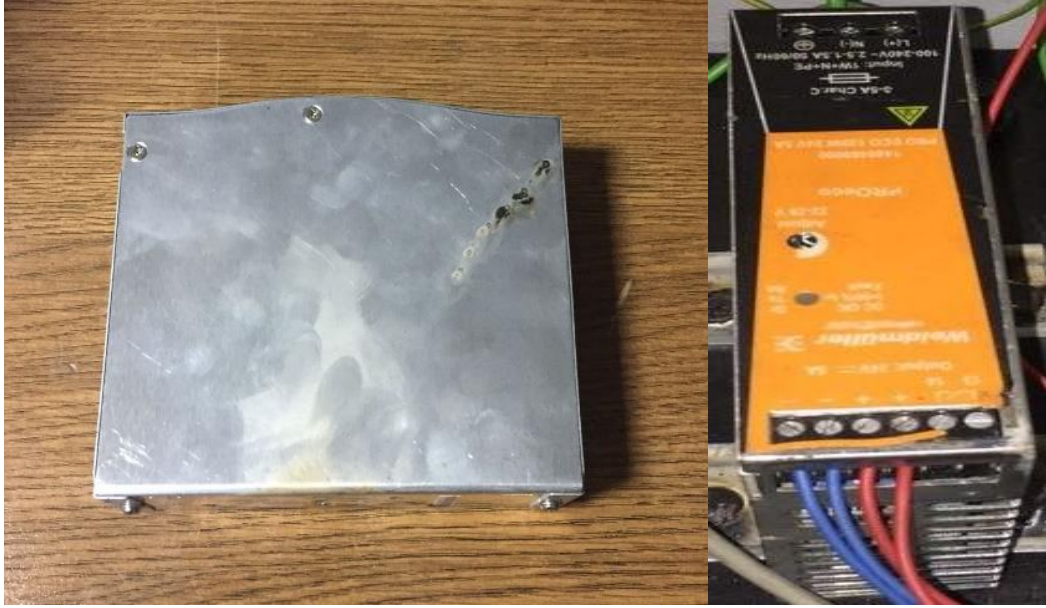
Şekil 4.14. a) yanan güç kaynağı b) yerine koyulan yeni güç kaynağı
