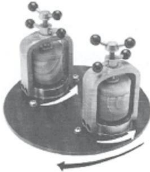
Şekil 3.3. Gezegen tipi öğütücünün dönüş şeklinin şematik olarak gösterimi
