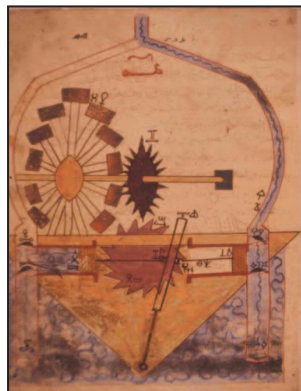
Şekil 1.3. Cezeri'nin tasarlamış olduđu pistonlu pompa [1]
