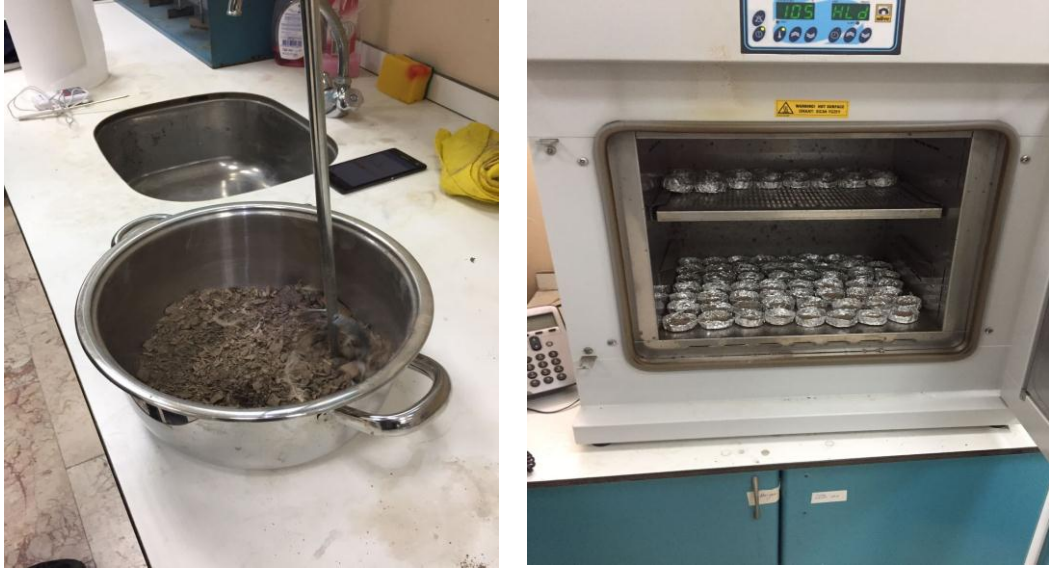
Şekil 3.6. Tavuk gübresinin sıcak biyokütle küllü ile karıştırılması ve karışımın nem miktarının belirlenmesi
