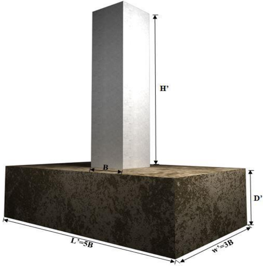
Şekil 3.2. Yapı-zemin etkileşim probleminin ölçekli modeli
