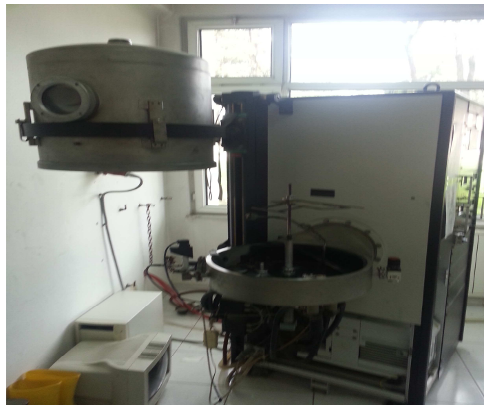
Şekil 3.14. Gebze Üniversitesi'nde kullanılan vakum buharlaştırma cihazı
